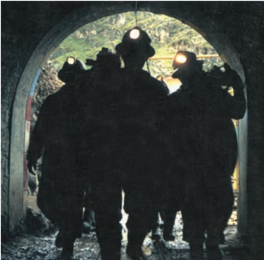
شکل ۴-۴- چراغ‌های انفرادی که نورافکن آن قابل نصب بر روی کلاه است و باطری آن به کمر نصب می‌شود.
