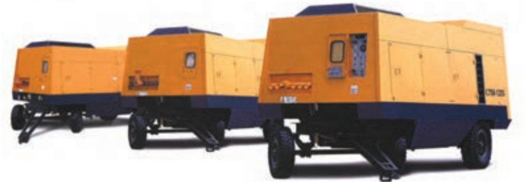
شکل ۶-۲ - ظرفیت‌های مختلف کمپرسورهای سیار معدنی
