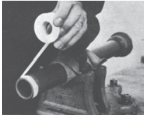
شکل ۲۷-۷- نوار تفلون و طریقه‌ی بستن آن به یک وصاله
