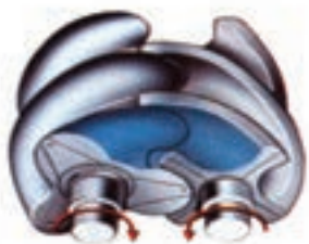
شکل ۱۰-۶- اصول کار کمپرسور پیچی
