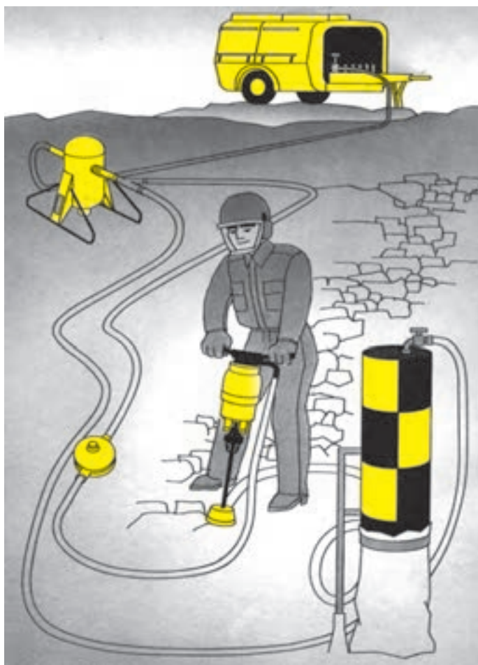
شکل ۱۴-۶- به وضعیت قرار گرفتن گردگیر، در ارتباط با تجهیزات هوای فشرده توجه کنید.
