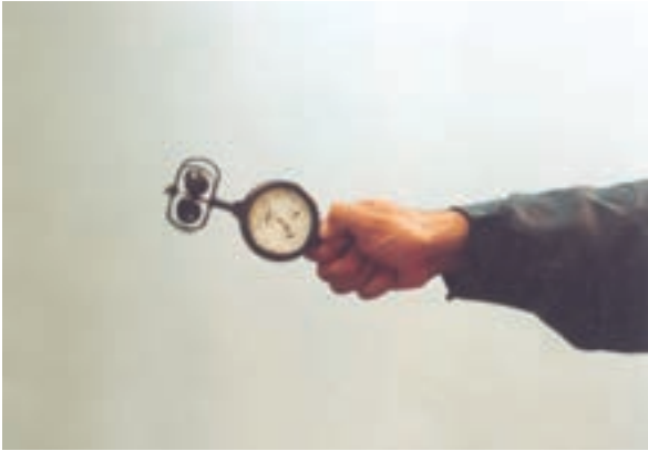
شکل ۸-۹ - طرز گرفتن هواسنج در مسیر جریان هوا
