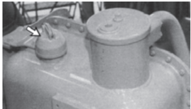
شکل ۹۱-۶ - پر کردن سیستم هیدرولیک فرمان از روغن
