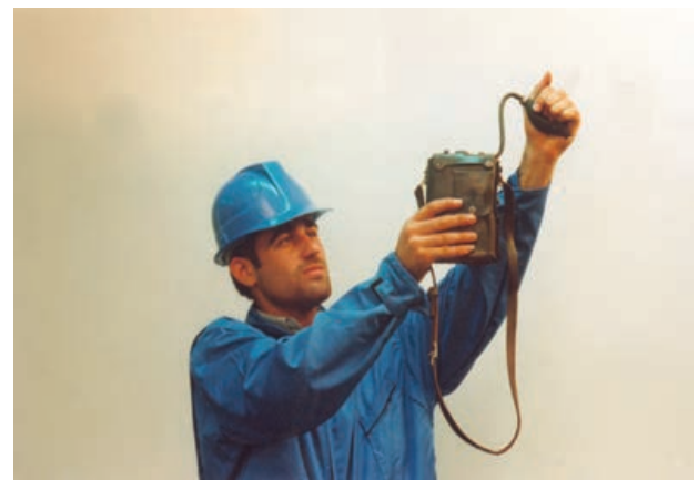
شکل ۷-۸- فشردن تلمبه لاستیکی و انتقال هوا به داخل اینترفرومتر
