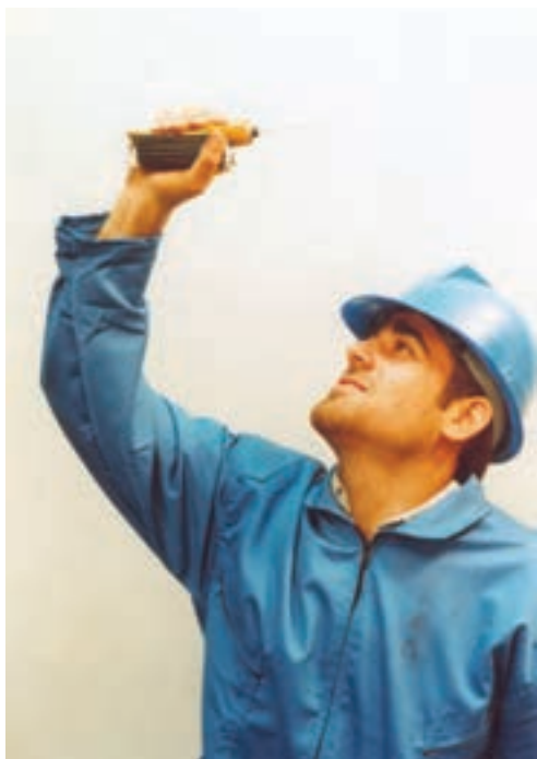
شکل ۱۵-۷ فشار دادن دستگاه برای جذب هوا
