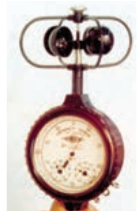
شکل ۱-۱-۸- آنومتر یا هواسنج فنجان‌ی
