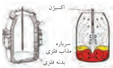
شکل ۲-۸ کوره L-D یکی از روش‌های تولید فولاد.
