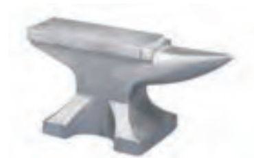
شکل ۹-۲ سندان از جنس فولاد
