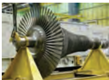
شکل ۲-۳۵ کاربرد فولادهای نسوز در تولید توربین‌های گازی
