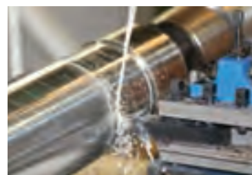
شکل ۲-۳۱ قطعه در حال تراش بدون براده‌برداری
