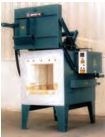
شکل ۸-۴ دیواره کوره از جنس سرامیک
