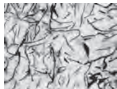
شکل ۲-۴۹ چدن خاکستری با گرافیت ورقه‌ای
