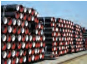
شکل ۲۰-۲ لوله‌های انتقال سیال
