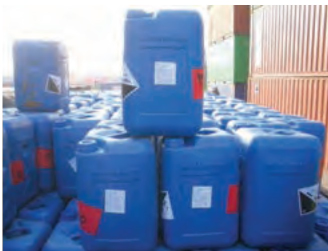
شکل ۲۰-۴ گالن‌های پلاستیکی نگهدارنده اسید
