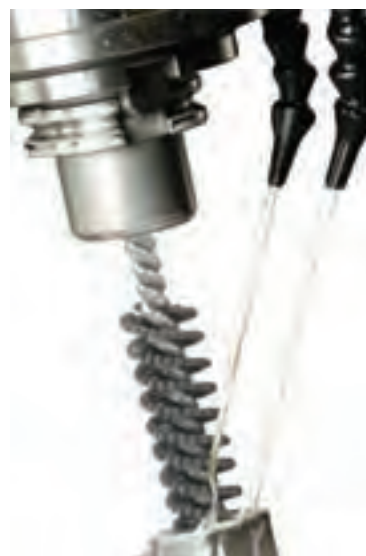
شکل ۳-۴ ابزار برش تولید شده از سرامیک برای تراشکاری فلزات
