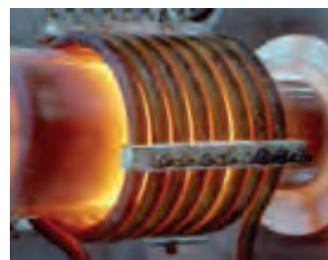
شکل ۲-۴۶ سختی سطحی به روش القایی
