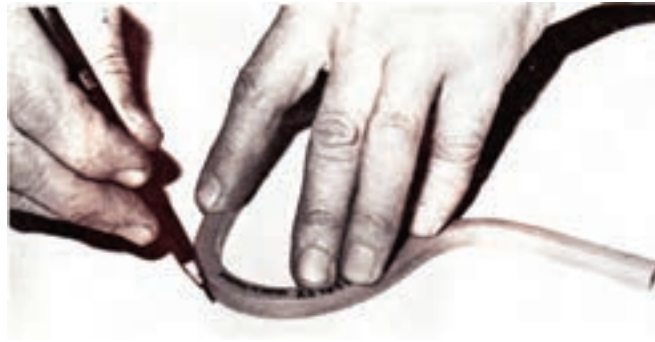
شکل ۲-۵۴- نمونه‌ی ترسیم خط منحنی توسط پیستوله‌ی ماری.
