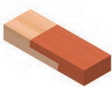
شکل ۹-۷۴- اتصال طولی نیم و نیم سرکج.
