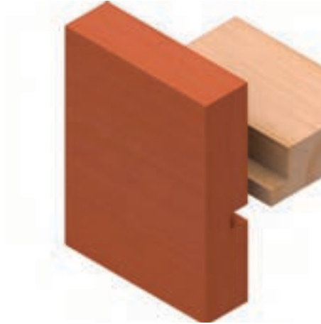
شکل ۹-۴۹- اتصال گوشه‌ی صفمات کنجشکاف.
