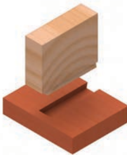
شکل ۹-۶۰- طریقه‌ی ترسیم اتصال گوشه‌ی صفحات گرات یک طرفه، با درز پایینی.
