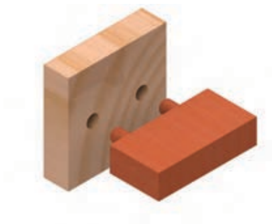
شکل ۹-۵۲- اتصال گوشه‌ی صفمات دابل با افتلاف سطح.
