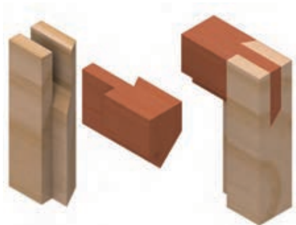
شکل ۹-۱۴- اتصال گوشه‌ای فاق و زبانه‌ی ساده با دوراهی و پیغ فارسی.
