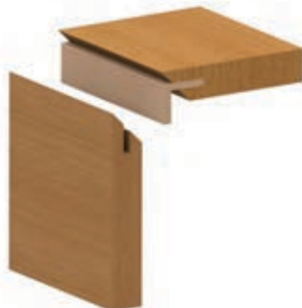
شکل ۹-۶۳- اتصال گوشه‌ی صفمات قلیف، با زبانه‌ی پیش ساخته از مواد مصنوعی.
