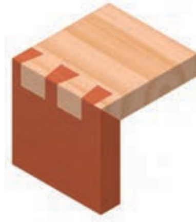
شکل ۹-۳۸- تصویر مجسم اتصال دم چلچله‌ی ساده با بر فارس.
