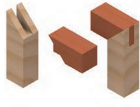
شکل ۹-۸- اتصال گوشه‌ای فاق و زبانه‌ی دو رو فارسی.
