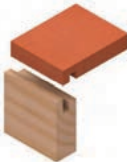
شکل ۹-۱۴۵- اتصال گوشه‌ی صفمات یک رو مففی، با دو کنشکاف و دو زبانه.
