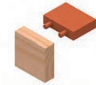
شکل ۹-۱۴۶- اتصال گوشه‌ی صفمات دو رو مففی (فارسی)، با دو کنشکاف و دو زبانه.
