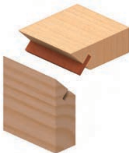
شکل ۹-۶۴- طریقه‌ی ترسیم اتصال گوشه‌ی صفمات قلیف، با زبانه‌ی پیش ساخته از مواد مصنوعی در نما.
