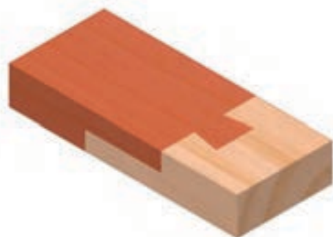
شکل ۹-۷۸- اتصال طولی نیم و نیم با دم چلچله‌ی یک یا دو طرفه.
