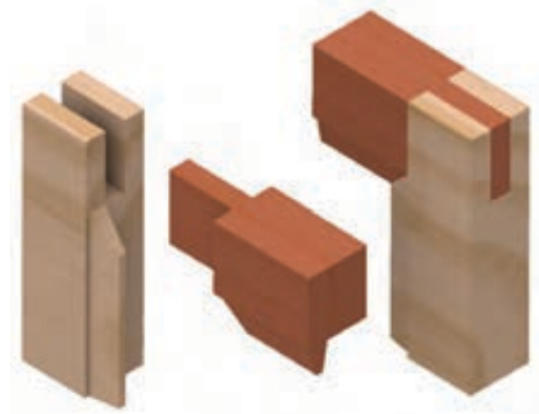
شکل ۹-۱۴- اتصال گوشه‌ای فاق و زبانه‌ی ساده با دوراهی و پیغ فارسی.
