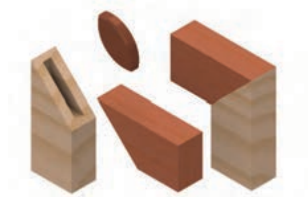
شکل ۹-۲۵- اتصال گوشه‌ای دو رو فارسی مخفی با زبانه‌ی کوتاه بیضی‌شکل (اتصال بیسکویتی).
