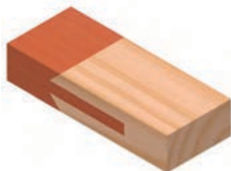
شکل ۹-۷۷- اتصال طولی فاق و زبانه‌ی سرکج.
