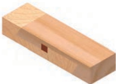
شکل ۹-۷۶- اتصال طولی گوه‌ای سر کج.
