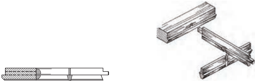
شکل ۹-۹۳- تصویر مجسم و برش اتصال متقاطع نیم ونیم، با دوراهاه و بر مایل بریده شده.
