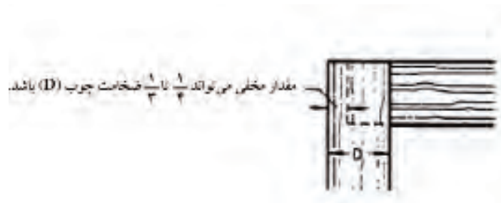
شکل ۹-۳۹ ب) طریقه‌ی ترسیم اتصال دم چلچله‌ی یک (و مخفی در نما).
