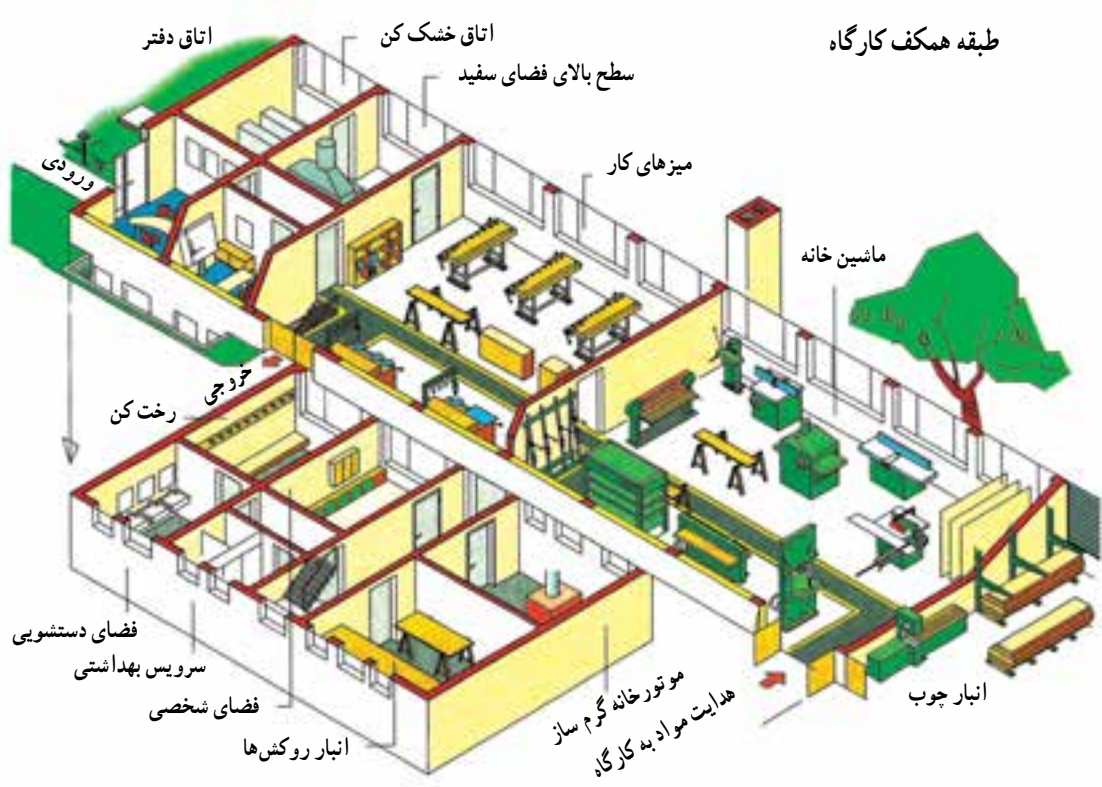
ماکت استقرار ماشین آلات و میزکار و مواد در تصویر مجسم از کارگاه بزرگ صنایع چوب
