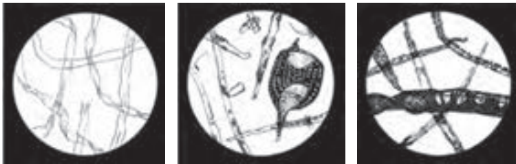
شکل ۱۵-۳- نمایش میکروسکوپی فیبرها با الیاف سالم
