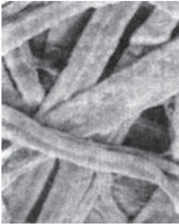
شکل ۵-۳- سلولز چوب مخروطداران با بزرگ‌نمایی ۴۲۰ برابر
