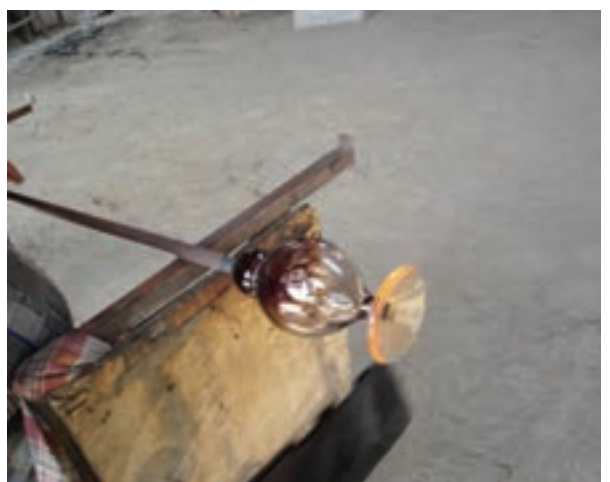
شکل ۱۱-۷- مراحل شکل‌دهی پایه شیء
