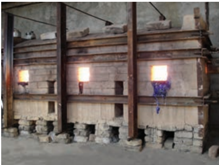
شکل ۴-۷- الف- ابزار و وسایل و تجهیزات شیشه‌گری سنتی - ب کوره شیشه‌گری سنتی
