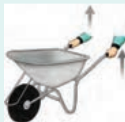
بالا آوردن دسته‌ها، گشتاوری ایجاد می‌کند که فرقون را حول نقطه‌ی چرخش می‌چرخاند.
