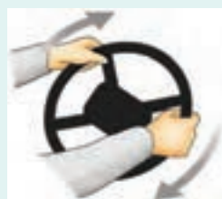
کشیدن یک دست و هل دادن دست دیگر، گشتاوری ایجاد می‌کند که فرمان را می‌چرخاند.
