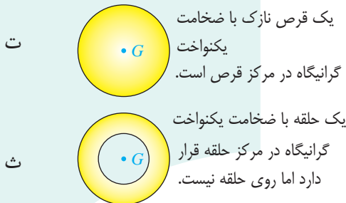
شکل ۴-۱۴ گرانیگاه چند جسم با شکل منظم که ماده‌ی تشکیل دهنده‌ی آن‌ها به طور یکنواخت توزیع شده است.
