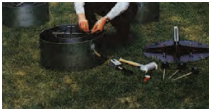
شکل ۱-۸- نحوه کار گذاشتن استوانه مضاعف
