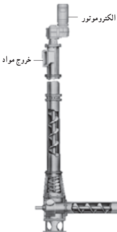
شکل ۲۰-۱- نقاله ماریچی مخصوص مسیرهای شیبدار
