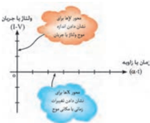
شکل ۱-۵۶- محورهای مختصاتی برای رسم شکل موج
