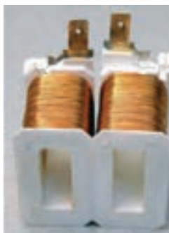
شکل ۱-۸۲ - سیم پیچ روی قرقره پیچیده شده
