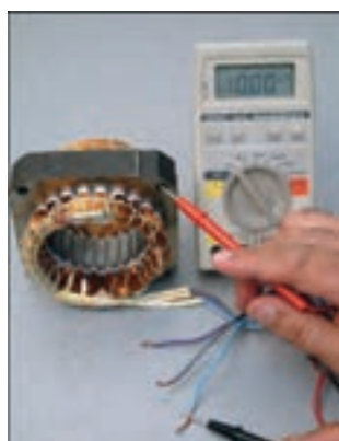
شکل ۱۸-۲- آزمایش اتصال بدنه
