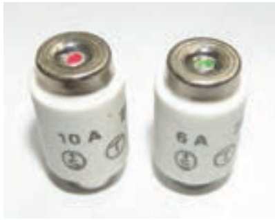
شکل ۴-۲- شدت جریان فیوز مطابق با رنگ پولک
