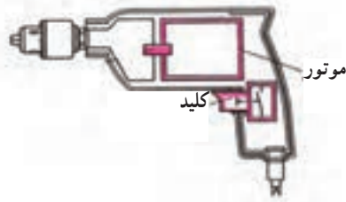
شکل ۱۹-۲- عایق مضاعف در دستگاه‌های متحرک
