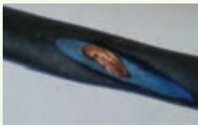
شکل ۲۲-۲- کابلی که روکش عایق آن با شیء بُرنده بریده شده است.
