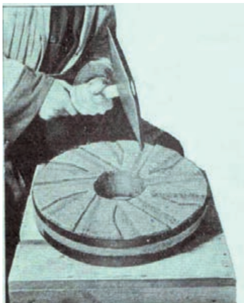
شکل ۳۹-۳ ایجاد شیار روی سنگ آسیا
