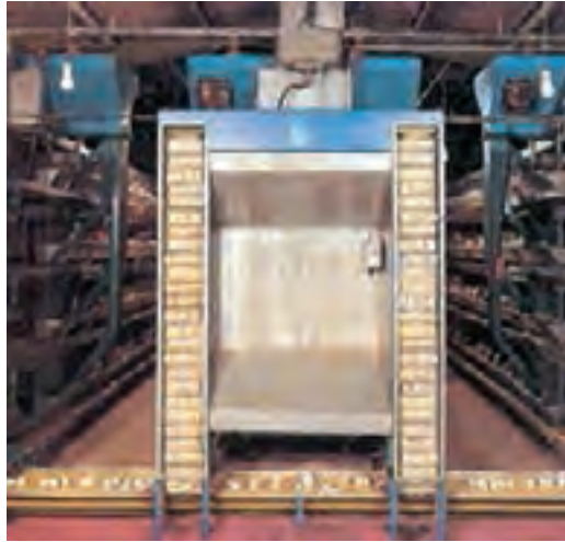
شکل ۷۸-۳- جمع آوری تخم مرغ‌ها در انتهای قفس‌ها
