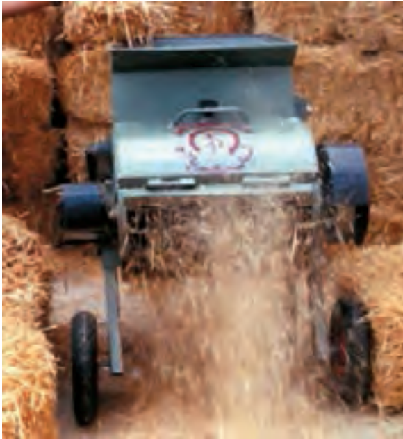
شکل ۳-۴- نحوه کار کاه خردکن
