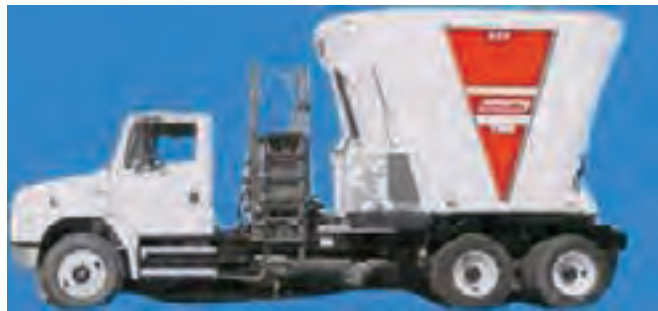
الف- ماشین خوراکه خرد و مخلوط کن عمودی تراکتوری ب- ماشین خوراکه خرد و مخلوط کن عمودی خودرو شکل ۴-۱۳
