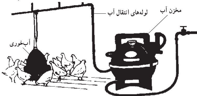
شکل ۶۱-۳- تجهیزات توزیع آب مکانیزه
