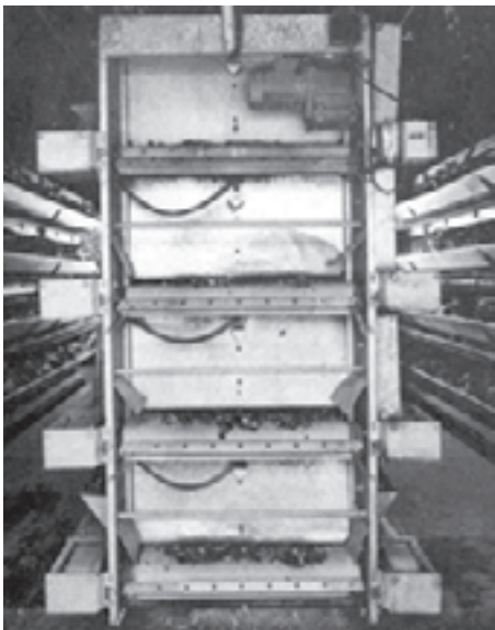
شکل ۷۹-۳- تسمه نقاله‌های جمع آوری فضولات در انتهای قفس
