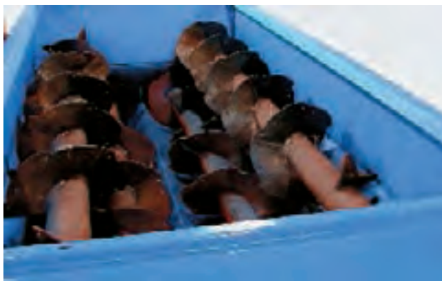
شکل ۴-۵ - ماریپیج‌های مخلوط‌کن در مخزن مواد
