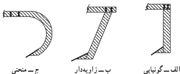
شکل ۵۲-۱- انواع ساق در گاو آهنهای زیرشکن
