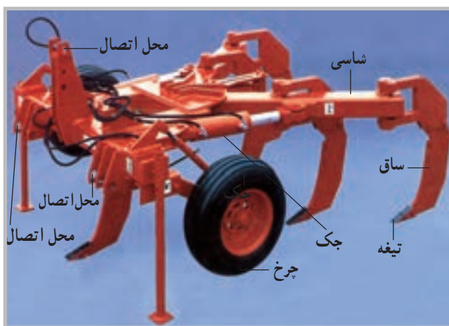
شکل ۵۴-۱- گاو آهن زیرشکن با جک هیدرولیکی و چرخ حامل
