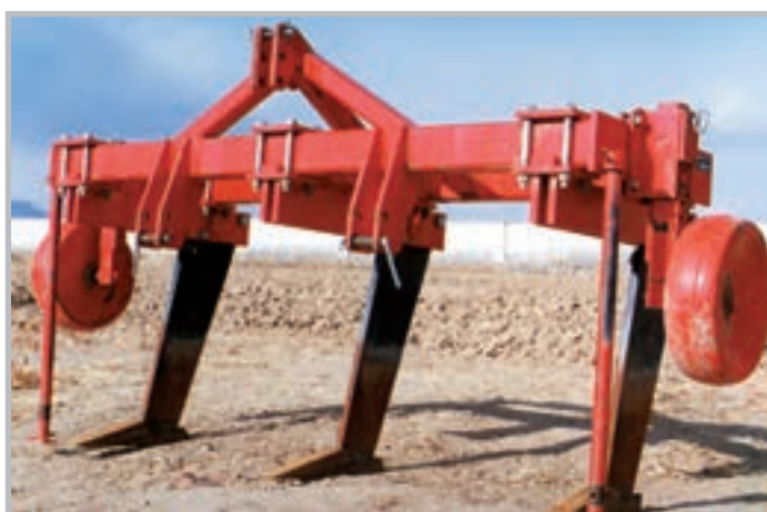
شکل ۵-۱- گاوآهن زیرشکن سوار
