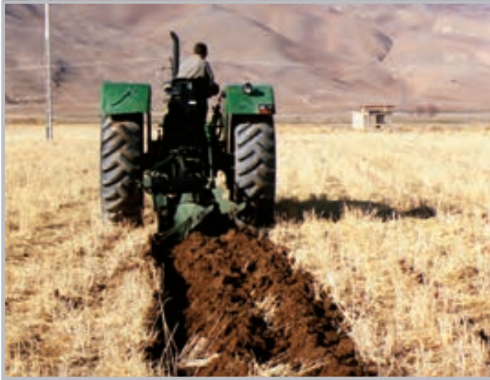
شکل ۳۲-۱- گاواهن برگردان‌دار سوار در حال شخم زدن
