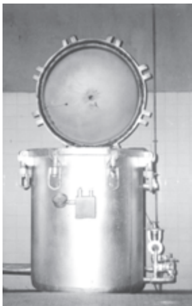
شکل ۲۲-۵ - دیگ پخت تحت فشار
