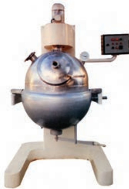
شکل ۱۷-۵- دیگ پخت غیرمداوم در فشار اتمسفر
