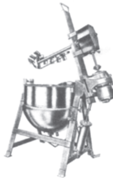
شکل ۱۸-۵- دیگ پخت همزن‌دار در فشار اتمسفر
