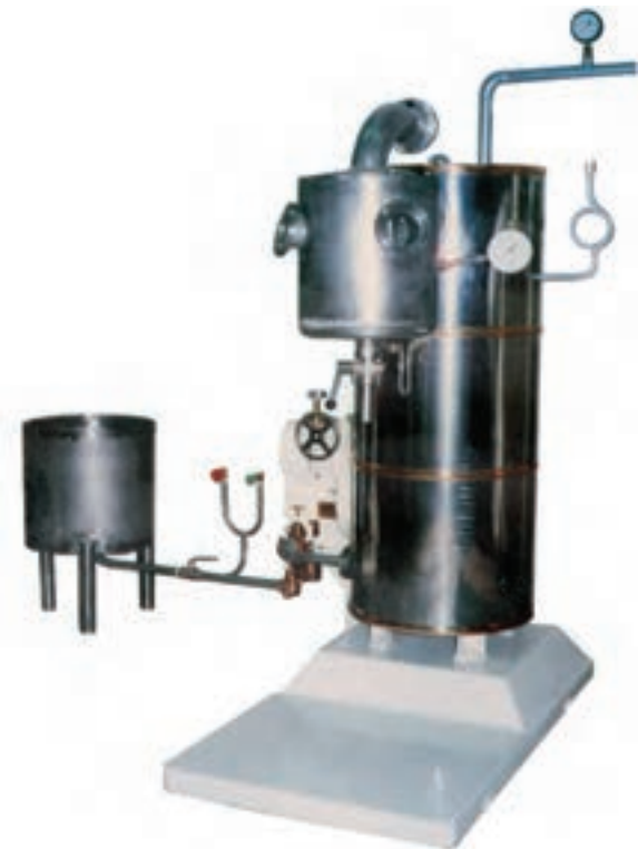
شکل ۱۹-۵- دیگ پخت مداوم در فشار اتمسفر
