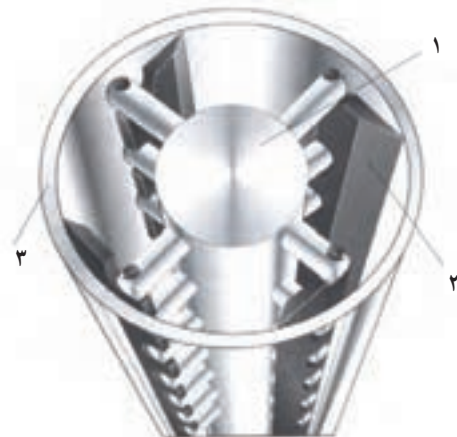
۱- محور چرخنده ۲- تیغه ۳- بدنه استوانه
