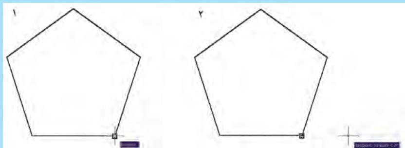
با تعیین نقطه‌ی اول خط، ماوس را به رأس فوقانی پنج ضلعی نزدیک و آن را تعیین می‌کنیم. سپس ماوس را به بیرون از پنج ضلعی حرکت می‌دهیم تا خط‌چین راستای رأس بالایی آن نیز نمایان شود. حال اگر رديابي قطبی نیز فعال باشد می‌توانیم به دو خط‌چین دست یابیم که يكی حاصل رديابي اشيا برای پنج ضلعی و دیگری حاصل رديابي قطبی راستای عمودی خط ترسیمی است.
