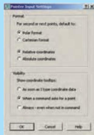
بدین ترتیب، همان‌گونه که در فصل قبل ملاحظه شد، وقتی پیش‌فرض بر روی مختصات نسبی قرار بگیرد، برای ورود اعداد مختصات، به قرار دادن علامت @ در ابتدای آن نیاز نیست. در بخش Visibility شرایط نمایش مختصات فعلی نشانگر ماوس تعیین می‌شود. در واقع کاربر تعیین می‌کند که در چه زمان‌هایی مختصات ماوس در کنار آن نمایش داده شود؛ به شرح زیر:
