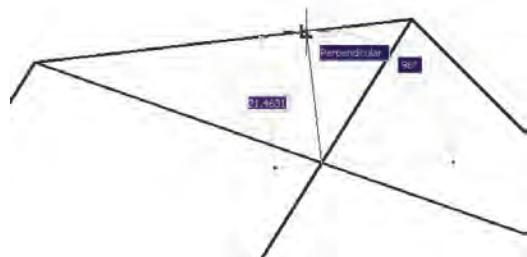
تمرین ۵: با استفاده از ابزار گیره‌ی شکل‌ها، تصویر زیر را ترسیم نمایید. (راهنمایی: ابتدا یک  $1^{\circ}$  ضلعی منتظم رسم نمایید و قطرهای آن را ترسیم کنید. در پیان رسم، خطوط داخلی را از رؤوس  $1^{\circ}$  ضلعی شروع کنید به گونه‌ای که این خطوط در جهت حرکت عقربه‌های ساعت به قطرهای عمود باشند.)
