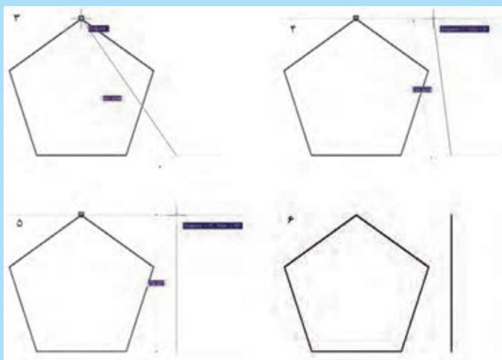
تنها تنظیم مربوط به ردیابی اشیا در کنار تنظیمات ردیابی قطبی قرار دارد. در اینجا اگر به جای گزینه‌ی Track using all polar angle settings، به جز راستاهای افقی و عمودی، کلیه‌ی راستاهایی که زاویه‌ی آن‌ها در ردیابی قطبی تعیین گردیده‌اند نیز به ردیابی امتداد اسکال اضافه می‌شود.
