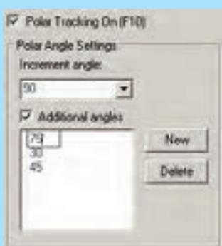
اکنون هنگام اجرای یک فرمان و رسم یک شکل با نزدیک شدن ماوس به هر کدام از زوایای ردیابی قطبی، آن راستا با یک خط چین نمایش داده شده و کافی است، با تایپ عدد طولی موردنظر، ترسیم را در جهت آن زاویه و با طول تایپ شده به انجام رسانیم. در تصویر صفحه بعد مشاهده می‌شود که هنگام ترسیم یک شکل، با استفاده از فرمان خط، قطعه خطی با طول  $80^\circ$  در راستای زاویه‌ی  $30^\circ$  درجه، که در ردیابی قطبی فعال گردیده، در حال رسم است.
