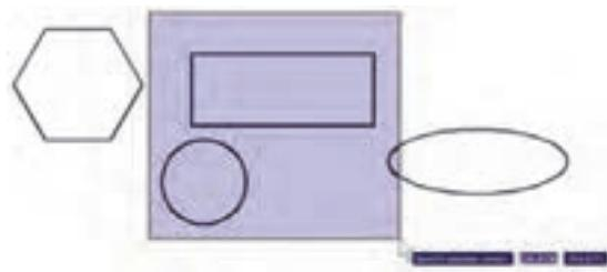
**۳- انتخاب پنجره‌ی برشی (Crossing Selection) :** برای انتخاب چندین شکل مجاور یکدیگر، می‌توان به جای پنجره‌ی کامل از پنجره‌ی برشی استفاده نمود. این پنجره از راست به چپ باز می‌شود و خطوط آن منقطع و رنگ داخل آن سبز است. نوع انتخاب این پنجره به این ترتیب است که به جز شکل‌های درون پنجره، مواردی که به وسیله‌ی پنجره قطع شده‌اند نیز انتخاب می‌شوند. در تصویر زیر انتخاب توسط پنجره‌ی برشی نمایش داده شده است.
