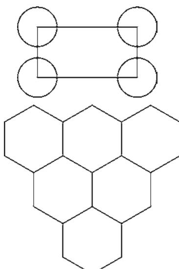
پاسخ به درخواست Specify second point ، نقطه‌ی دوم به اتوکد داده شود. در واقع فاصله‌ی بین نقطه‌ی مبنا و نقطه‌ی دوم میزان جایه‌جاگی است که برای شکل‌های انتخاب شده درنظر گرفته شده است. برای تعیین نقطه‌ی دوم نیز می‌توان هم از ماوس و هم از تایپ مختصات استفاده نمود و کاربر باید توجه داشته باشد که مختصات نقطه‌ی دوم را می‌تواند به صورت نسبی نیز وارد کند (یعنی نسبت به نقطه‌ی مبنا). در تصویر زیر چگونگی جایه‌جاگی یک شش ضلعی منتظم به نمایش درآمده است.
