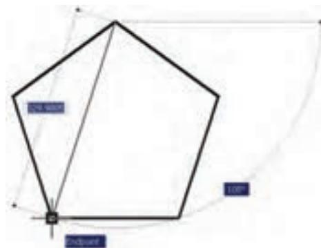
تمرین ۱: با استفاده از ابزار گیره‌ی شکل‌ها، تصویر زیر را ترسیم نمایید. (از Line و polygon استفاده کنید.)
