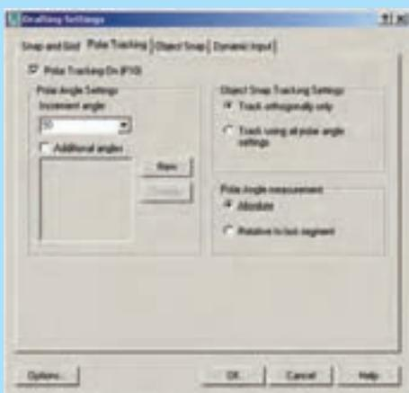
در بخش Increment angle زاویه‌ای پیش‌فرض در پنجره‌ی Polar Angle Settings تعیین می‌شود که وقتی  $90^\circ$  باشد راستاهای افقی و عمودی را شامل می‌شود. اگر کاربر بخواهد زوایای دیگری را به این مکان اضافه
