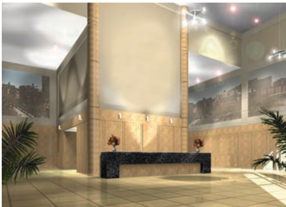
شکل ۳۷-۲- از پرسپکتیو دو نقطه ای برای ترسیم و آرایه ی کیفیت فضاهای داخلی و حجم بیرونی ساختمان استفاده می شود.
