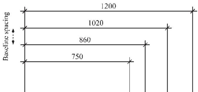
در تنظیمات خط اتصال، گزینه‌ی Extend beyond dim lines برای تعیین میزان امتداد یافتن این خط‌ها نسبت به خط اندازه به کار می‌رود. گزینه‌ی Offset from origin فاصله‌ی خط اتصال را از شکل اصلی اندازه‌گذاری شده تعیین می‌نماید.
