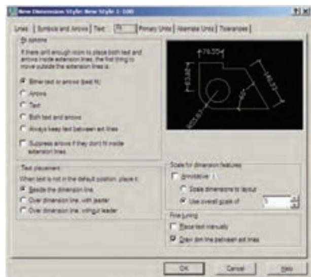
**۴—جای‌گیری صحیح اجزای اندازه (Fit):** مهم ترین وظیفه‌ی این حوزه، در شرایطی که محدودیت مکانی وجود دارد، تعیین وضعیت قرارگیری اجزای اندازه‌گذاری است. زمانی که اندازه‌گذاری بر روی یک فاصله‌ی کوچک مانند ضخامت یک دیوار در پلان اعمال می‌شود، معمولاً قرارگیری هر دو بخش متن اندازه و پیکان‌ها در دو سمت خط اتصال ممکن ندارد. در این حال روش‌های مختلفی برای حل این مشکل وجود دارد و هریک از نقشه‌کشان یکی از آن‌ها را برای خود انتخاب می‌کنند و برخی از آن‌ها در شکل زیر دیده می‌شود.
