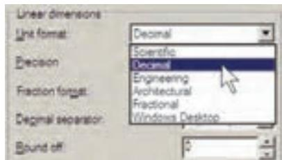
در پنجره‌ی Precision تعیین می‌کنید که اندازه‌های درج شده تا دقت چند رقم اعشار را نمایش دهند.
