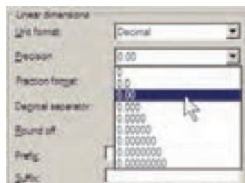
اگر واحد اندازه را در پنجره‌ی Unit format بر روی Fractional یا کسری تنظیم کرده باشید در بخش چگونگی نمایش کسر را تعیین خواهید کرد. علامت اعشار را انتخاب در Decimal separator می‌کنید. این علامت می‌تواند یک جای خالی (Space) ، کاما (Comma) یا نقطه (Period) باشد.
