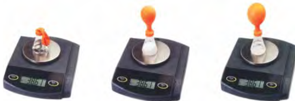
آ) بادکنک مانع از خروج فرآورده از ظرف واکنش می‌شود از این رو جرم کل مخلوط واکنش ثابت می‌ماند. (واکنش کلسیم کربنات با محلول هیدروکلریک اسید)
