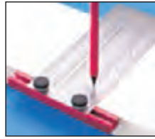
شکل ۱-۳۴ قرقره‌های متصل کننده‌ی خط کش به میز
