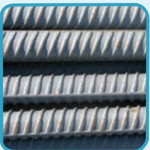
شکل ۱۷-۱- میلگرد با رویه آجدار
