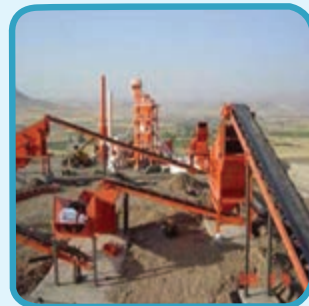
شکل ۱-۳- دانه‌بندی شن و ماسه
