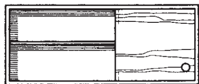
شکل ۲-۵۲- تصویر مجسم کابینت و طبقه با زیرسری زبانه‌دار مفتولی و انواع آن.
