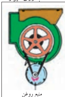
شکل ۹۸-۱- نصب از سقف
