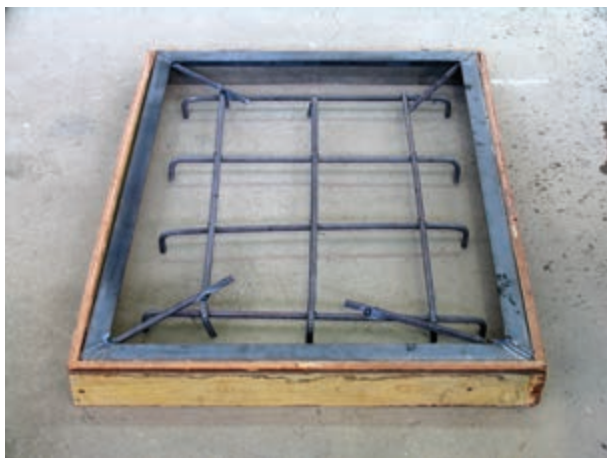
شکل ۵-۱- قرارگیری میل‌گردها در قالب
