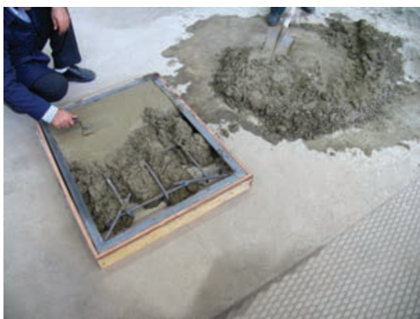
شکل ۶-۱- پر کردن قالب با ملات مناسب
