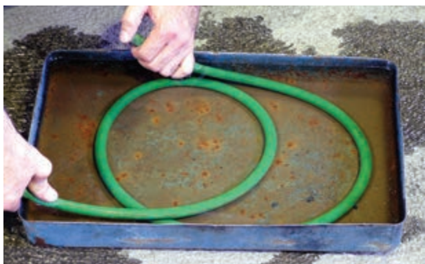
شکل ۲-۹۹- کنترل نشتی شیلنگ در آب
