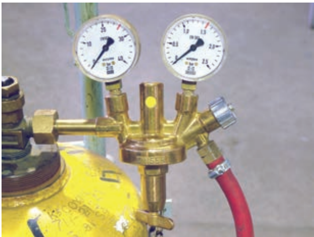
شکل ۱۳۵-۲ پیچ تنظیم فشار استیلن روی رگولاتور
