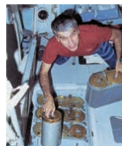
یک فضاپنورد در حال تعویض قوطی‌های تصفیه هوای فضاپیما است.
