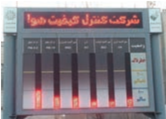
نمایشگر آلاینده های هوا. در این نمایشگر غلظت اغلب آلاینده ها با ppm نمایش داده می شود.
