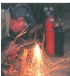
شکل ۵ برشکاری با اتین
