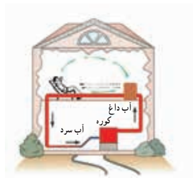
شکل ۶-۱۴- گرم شدن هوای اتاق به روش همرفت
