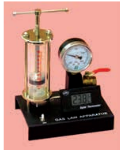
شکل ۲۴-۶- دستگاه تحقیق قانون گازهای کامل
