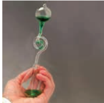
شکل ۲۳-۶- با در دست گرفتن جباب شیشه‌ای و گرم کردن آن، مایع رنگی در لوله ماریچ بالا می‌رود.
