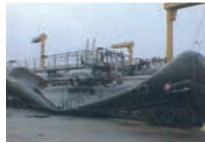
شکل ۲۲-۶- سرد شدنِ هوای درون مخزن باعث کاهش فشار این هوا و در نتیجه می‌شکند مخزن شده است.
