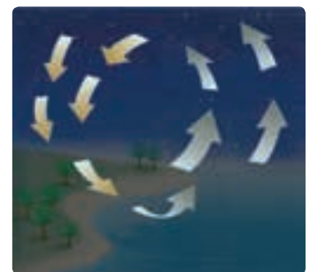
شکل ۶-۱۵- جریان های باد ساحلی در شب و روز، ناشی از پدیده همرفت. به جهت چرخش هوا توجه کنید.
