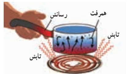
شکل ۶-۹- در این شکل، هر سه روش انتقال گرما را در تصویری مشاهده می‌کنید.
