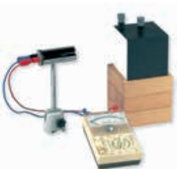
شکل ۶-۲۰- درون مکعب سیلی آب داغ می‌ریزند. تابش گرمایی از چهار وجه جانبی مکعب، که رنگ‌های متفاوتی دارند، با هم فرق دارد.
