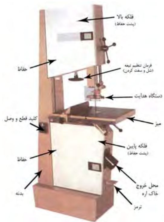
شکل ۴۱-۱. قسمت‌های مختلف یک ماشین اره‌نواری.
