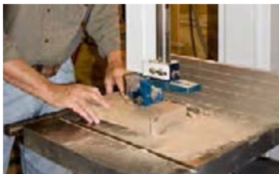
شکل ۱-۳۵- ا. فاصله‌ی ارتفاع سطح چوب با دستگاه هدایت.
