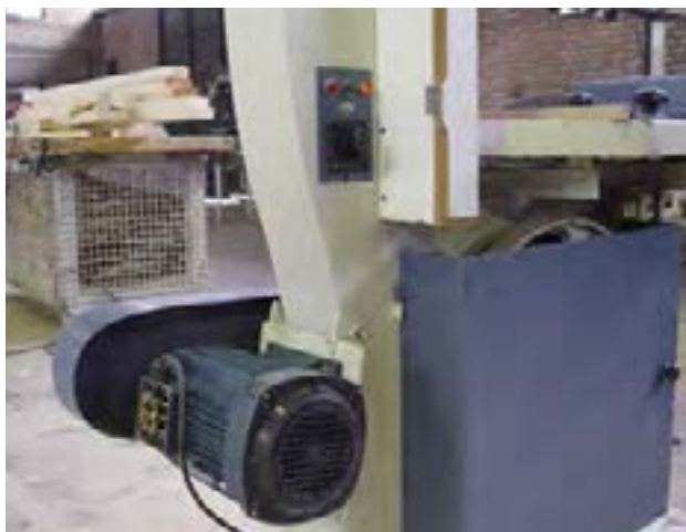
شکل ۲۷-۱- الکتروموتور تک فاز با فازن راه انداز.
