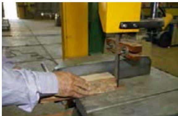
شکل ۱-۳۶- ا. برش با اره پس از یک رو و یک نر کردن.
