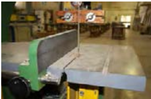
شکل ۱۲-۱- گونیا ثابت یا طولی.
