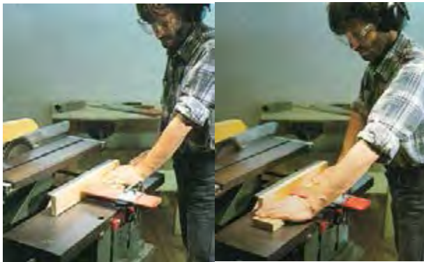
شکل ۱-۴۴-۱- گونیایی کردن چوب قبل از برش.
