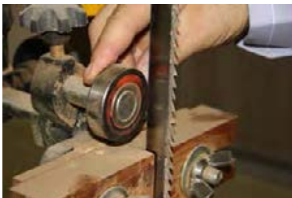
شکل ۳۰- ۱- کنترل بلبرینگ پشت تیغه.
