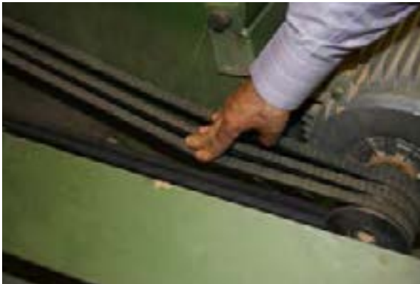
شکل ۲۲-۱- تنظیم سفتی تسمه
