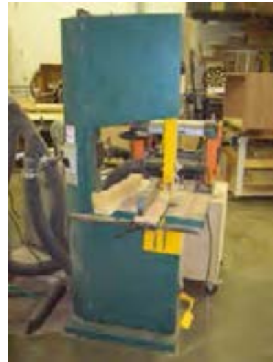
شکل ۹-۱- یک ماشین اره‌نواری، با حفاظ کامل.
