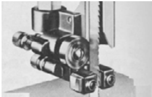
شکل ۱۵-۱- نمونه تنظیم دستگاه هدایت تیغه اره، تعبیه شده در بالای میز.
