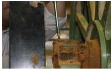
شکل ۳-۱۳. گریس کاری یاتاقان فلکه اره.
