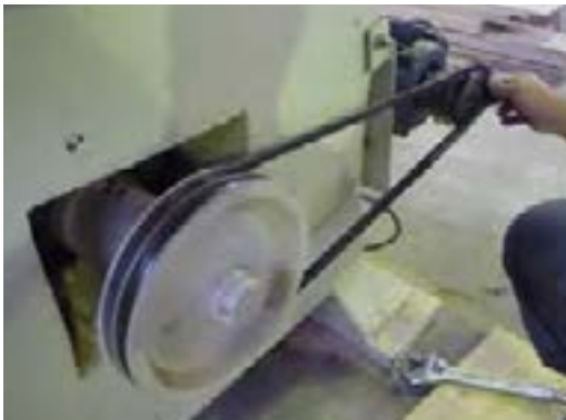
شکل ۳-۱۶. تعویض تسمه فرسوده.
