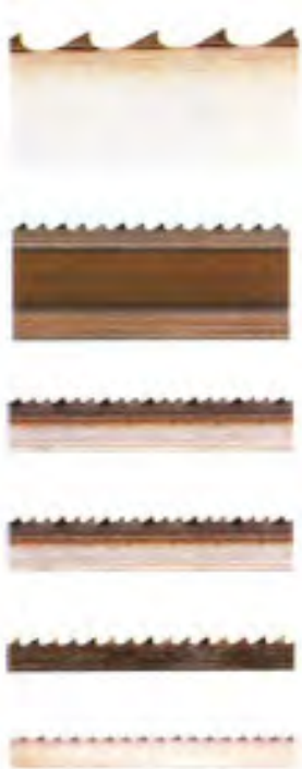
شکل ۱-۴۸-۱- فرم‌های مختلف دندانه‌ی اره‌نواری.
