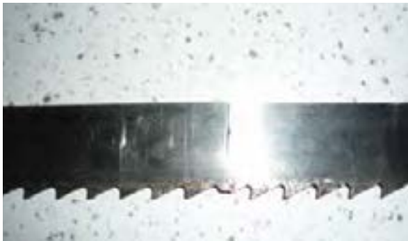
شکل ۱-۷۰- ترک تیغه اره از محل جوش.
