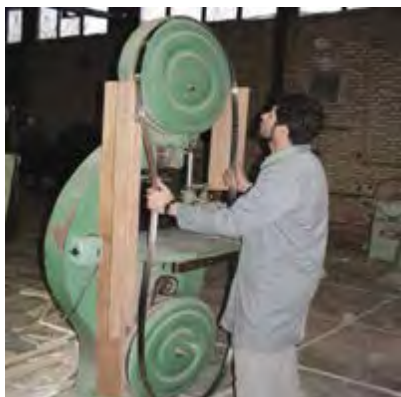
شکل ۲-۵- خارج کردن تیغه اره از روی فلکه‌ها.
