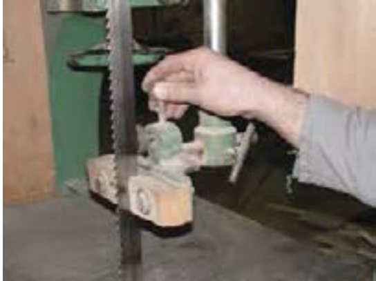
شکل ۵۲-۱- نمونه‌ی تنظیم فاصله‌ی بلبرینگ با پشت تیغه.
