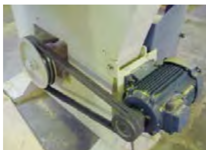
شکل ۳-۴. انتقال نیرو توسط تسمه.
