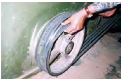
شکل ۹-۳- چگونگی تعویض تسمه.
