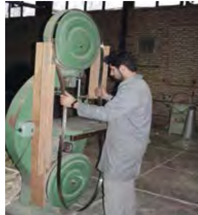
شکل ۶-۲- نمونه‌ی جا انداختن تیغه اره.
