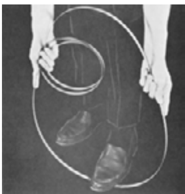
شکل ۸-۳- تبدیل کردن تیغه اره از ۳ حلقه به ۵ حلقه.
