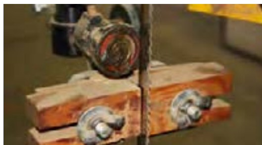
شکل ۳-۲. گریس‌کاری بلبرینگ تیغه (اره).
