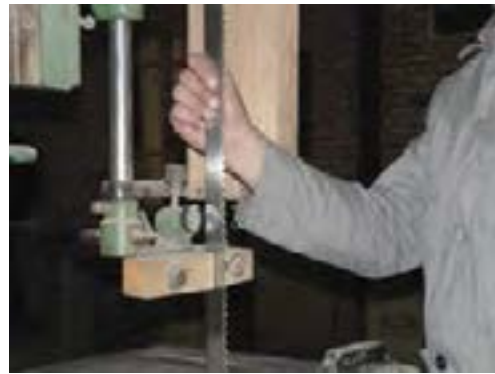
شکل ۵۱-۱- کنترل سفتی تیغه به کمک دست.
