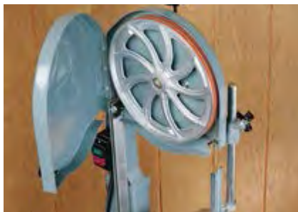
شکل ۲-۴- مفاظ باز شده‌ی روی فلکه و تیغه.
