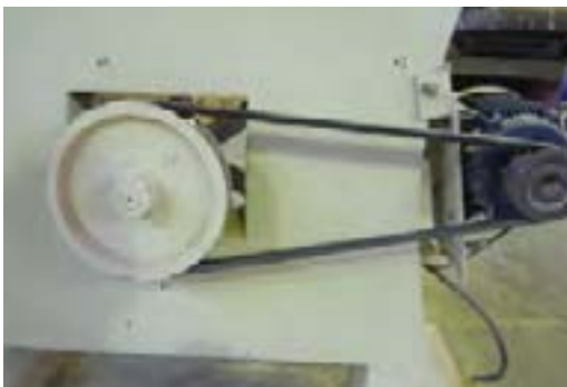
شکل ۳-۱۷. استقرار تسمه در داخل چرخ تسمه.
