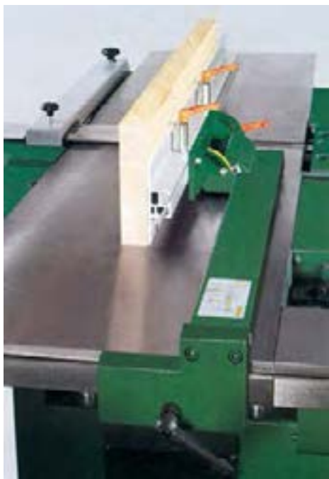
شکل ۶-۴- یک نوع گونیای متمرک و متصل به ماشین رنده.
