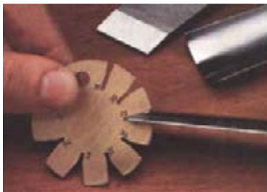
شکل ۴-۵- شابلن مخصوص کنترل زاویه‌ی رنده.
