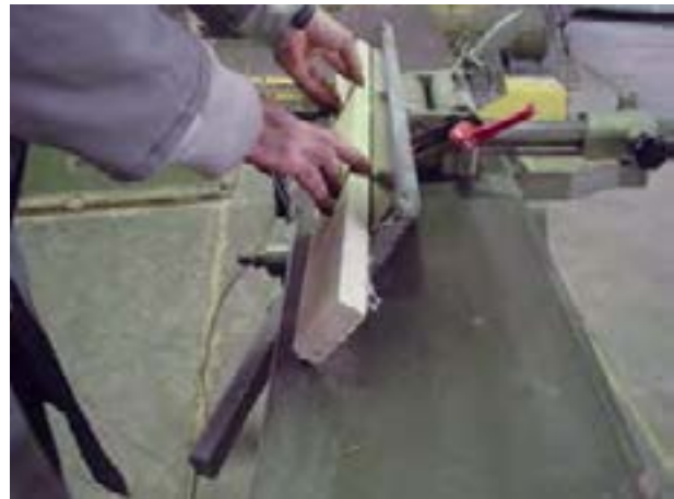
شکل ۳۵-۴- رنده کردن نر چوب با زاویه ۴۵ درجه.
