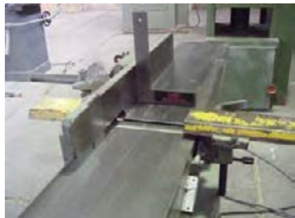
شکل ۳۰-۴. کنترل گونیا ماشین.
