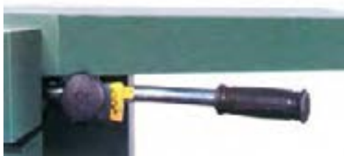
شکل ۸-۴- اهرم تنظیم بار صفحه‌ی کفرند.
