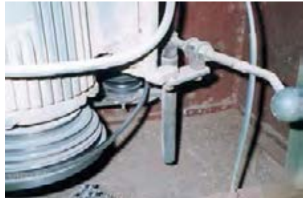
شکل ۱۱-۶- فایز کردن تسمه از پولی.
