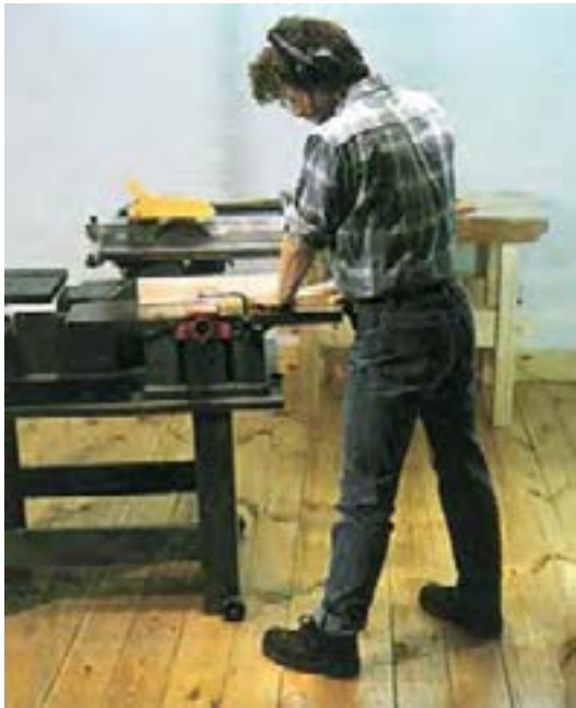
شکل ۳۱-۴. ایستادن صحیح در کنار ماشین.
