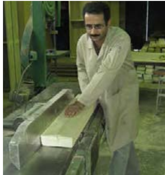
شکل ۱۶-۴- طرز ایستادن صحیح در کنار ماشین.
