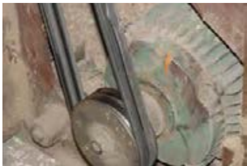
شکل ۱۰-۶ باز کردن حفاظ تسمه.
