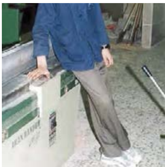
شکل ۱۹-۴- تماس دست با تیغه قطر آفرین است.
