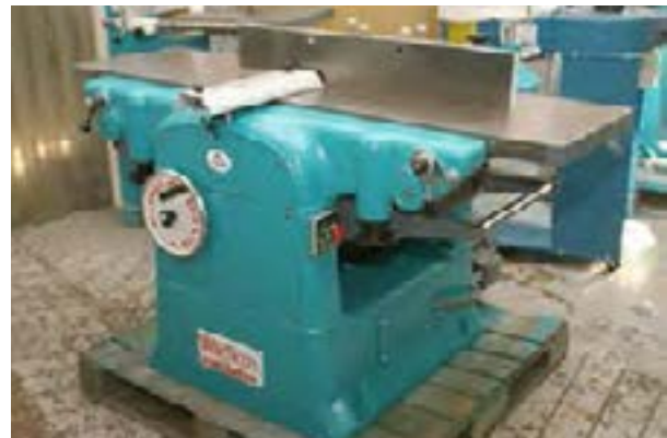
شکل ۴-۴- ماشین کفرند با بدنه چدنی.
