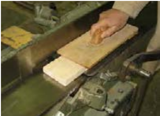
شکل ۱۷-۴-ب - رنده کردن چوب‌های کم ضخامت.
