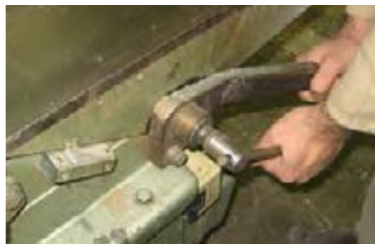
شکل ۱۳-۵- تنظیم مقدار بار.
