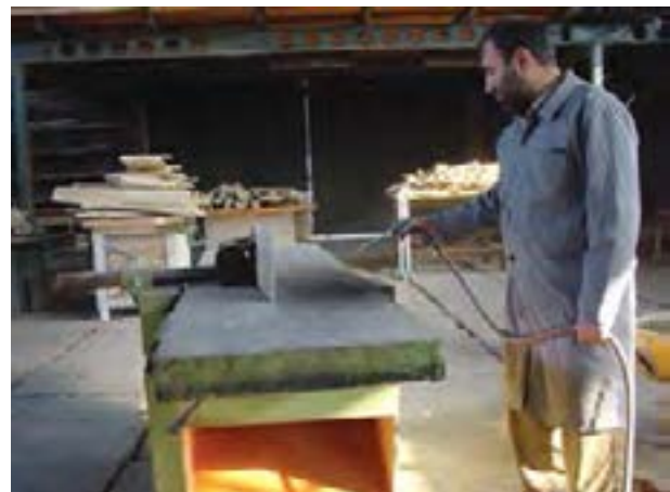
شکل ۱۲-۶- غبارگیری ماشین با شیلنگ باد.
