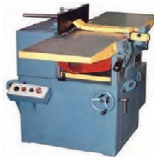
شکل ۴-۳۲- ماشین رنده با حفاظ.
