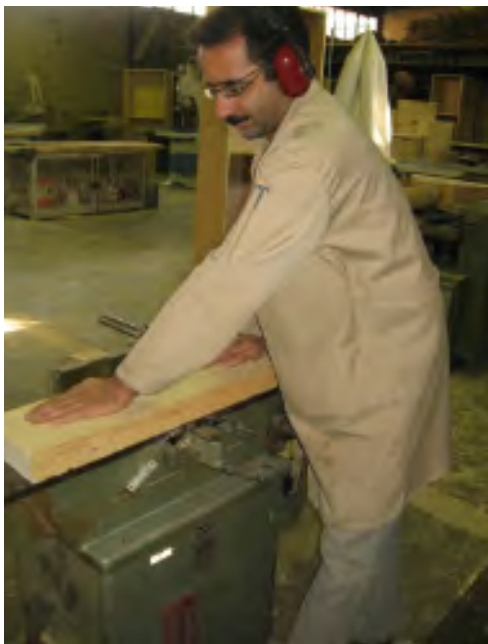
شکل ۴-۲۹- استفاده از گوشه‌ی و عینک ایمنی هنگام کار
