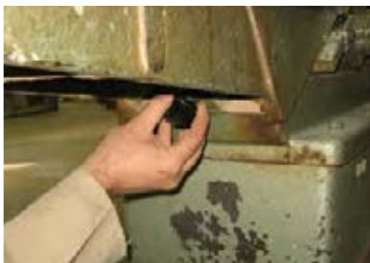
شکل ۹-۴- اهرم ثابت کننده‌ی صفحه.
