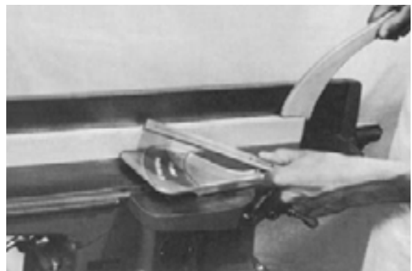
شکل ۱۷-۴- الف - رنده کردن انتهای چوب‌های باریک.
