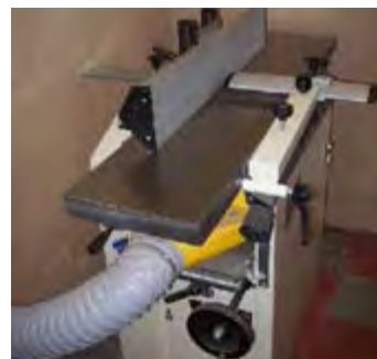
شکل ۴-۲۲ - مکنده‌ی قابل اتصال به ماشین کفرند.
