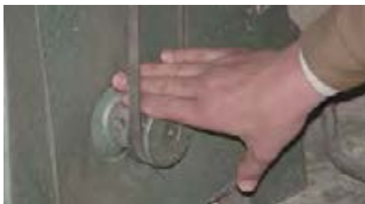
شکل ۵-۶- مراقبت از انگشتان به هنگام تعویض تسمه.
