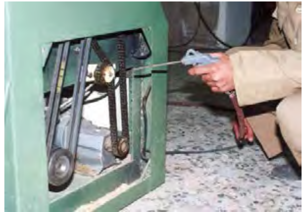
شکل ۸-۱۵- بادگیری داخل قسمت انتقال نیرو.
