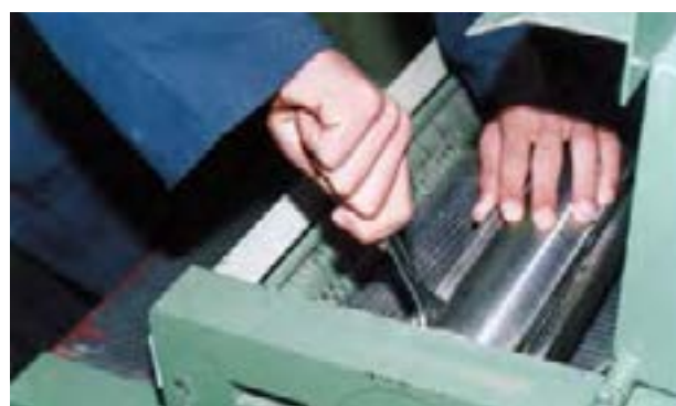
شکل ۲۴-۷- نمونه‌ی بستن تیغه‌ها به توپی.
