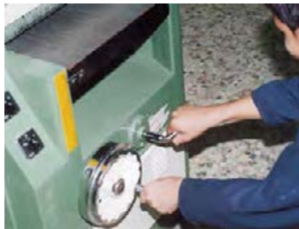
شکل ۱۹-۷- تنظیم صفحه و مکم نمودن اهرم مربوطه.
