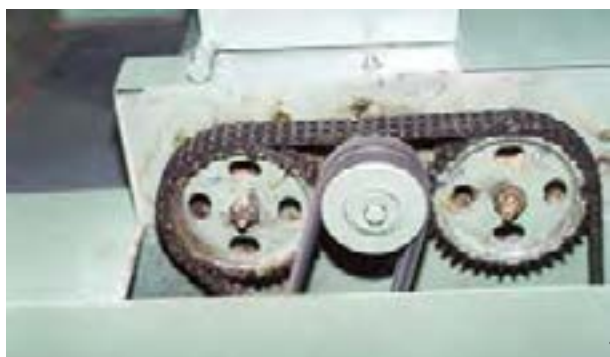
شکل ۱۸-۷- زنجیر انتقال نیرو و قدرت به غلتک‌ها.
