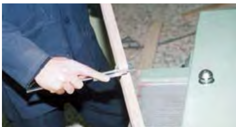
شکل ۳۸-۷- کنترل مرمله‌ای، جهت اطمینان از صمت اندازه.
