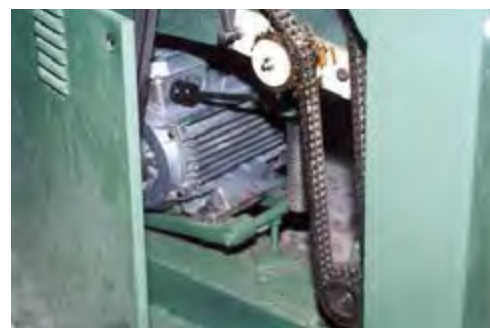
شکل ۱۳-۷- حفاظ تسمه، زنجیر، الکتروموتور و ...
