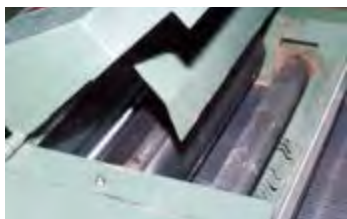
شکل ۲۲-۷- برداشتن درپوش تیغه‌ها.
