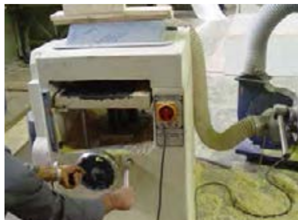
شکل ۷-۴۰- تنظیم دهانه‌ی گندگی.
