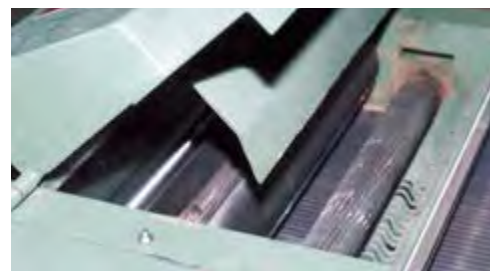
شکل ۱۲-۷- حفاظ توپی تیغه‌ها و غلتک‌ها
