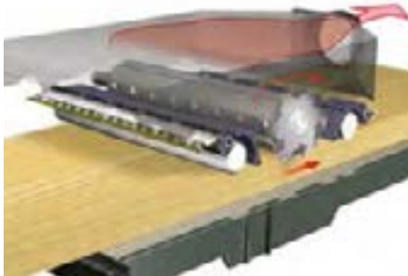
شکل ۸-۷- غلتک آبدار، توپی تیغه‌ها و غلطک صاف.
