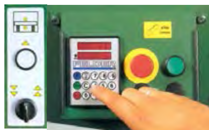
شکل ۷-۲- کلید و راهنمای بالابر اتوماتیک و تنظیم ضخامت با
