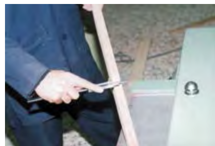
شکل ۴۸-۷- کنترل ضخامت چوب گندگی شده، با کولیس.
