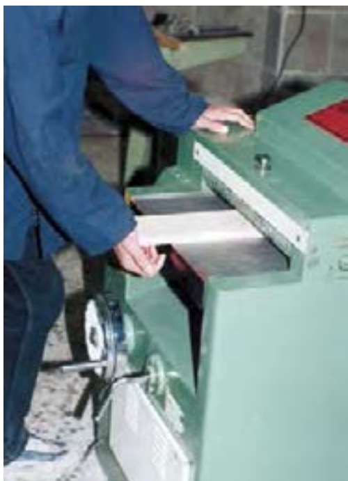
شکل ۷-۴۲- (روش ایمنی هدایت چوب به داخل ماشین).
