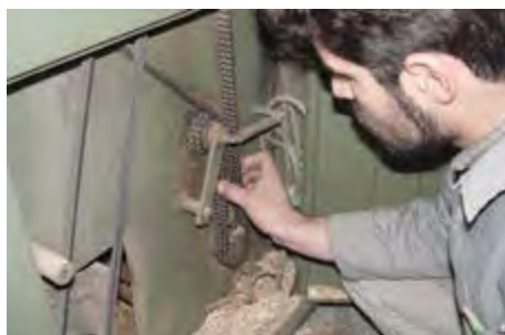
شکل ۲۷-۷- تنظیم و آزمایش سفتی زنجیر انتقال نیرو.
