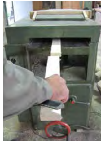
شکل ۷-۳۲ - روش صحیح وارد کردن چوب.
