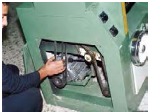
شکل ۸-۱۶- کنترل تسمه‌های انتقال نیرو
