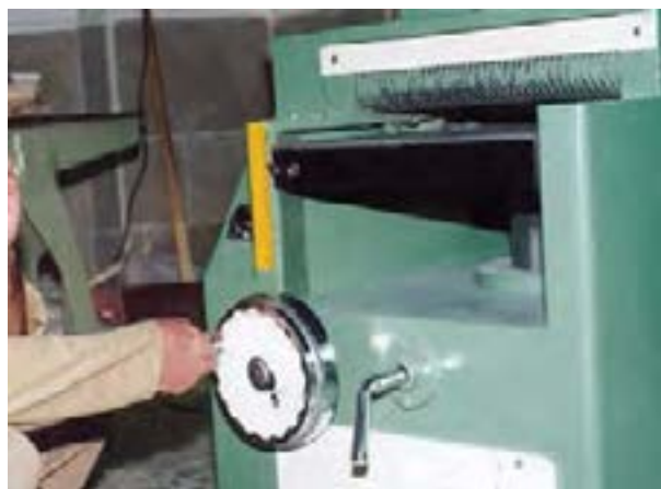
شکل ۷-۴۴- تنظیم مجدد اندازه.
