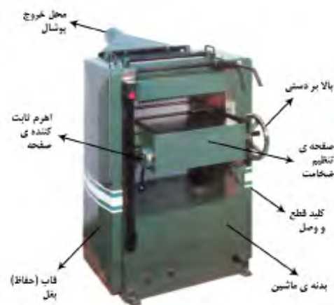
شکل ۵- ۷- مشخصات ظاهری ماشین گندگی.
