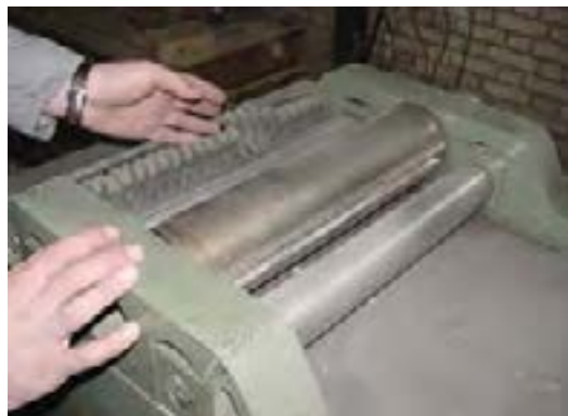
شکل ۷-۲۹- کنترل تمیزی شانه‌ها.
