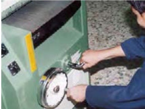
شکل ۷-۳۴ - تنظیم مقدار بار گندگی.
