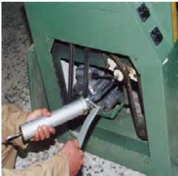
شکل ۸-۷- گریس‌کاری مموره‌های انتقال نیرو.
