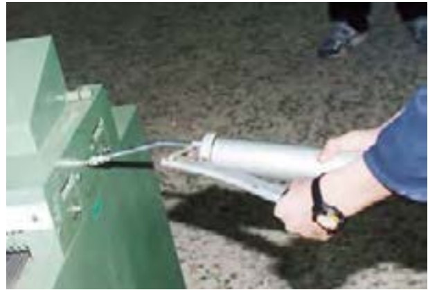
شکل ۸-۱. گریس‌کاری بلبرینگ یاتاقان‌ها.
