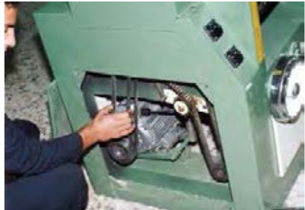
شکل ۸-۸- کنترل مقدار کشش تسمه‌ها.
