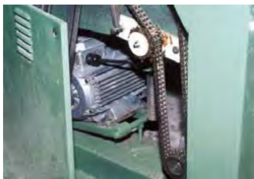
شکل ۸-۱۴- باز کردن درپوش برای روغن‌کاری.
