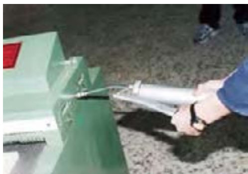
شکل ۸-۱۳- گریس‌کاری یاتاقان‌های ماشین.
