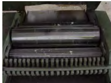
شکل ۱۰-۷ غلتک صاف (صیقلی).
