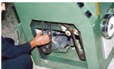
شکل ۲۶-۷- کنترل سفتی تسمه‌ی انتقال نیرو.
