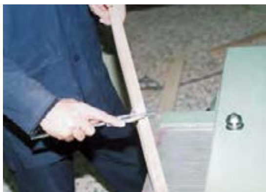
شکل ۷-۴۳- کنترل اندازه‌ی ضخامت، پس از خروج از دستگاه.
