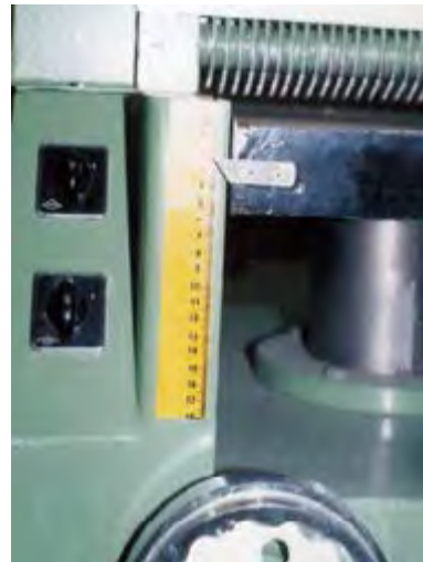
شکل ۷-۷- دو کلید ماشین گندگی.
