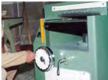
شکل ۲۱-۷- آزمایش روان بودن مرکب صفحه‌ی متمرک.
