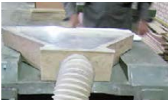
شکل ۱۷-۷- دهانه‌ی فروغ پوشال، توسط تبدیل مخصوص به سیستم مکنده متصل شده است.
