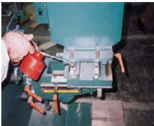
شکل ۱۳-۱- روغن‌کاری ممل ریل‌ها.
