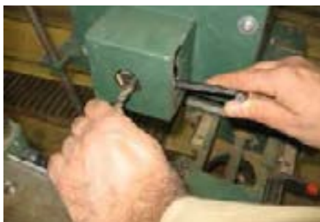
شکل ۹-۱۷- مهم‌ کردن مته داخل سه‌نظام.
