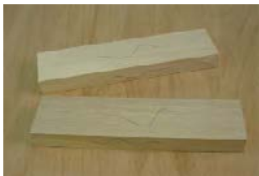
شکل ۹-۱۴- علامت یک (و) و یک نر چوب کُم کنی.
