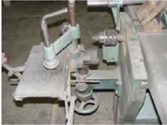
شکل ۹-۲ - ماشین سه‌کاره شامل: کُم‌کنی، رنده و اره گرد (مجموعه‌ای).
