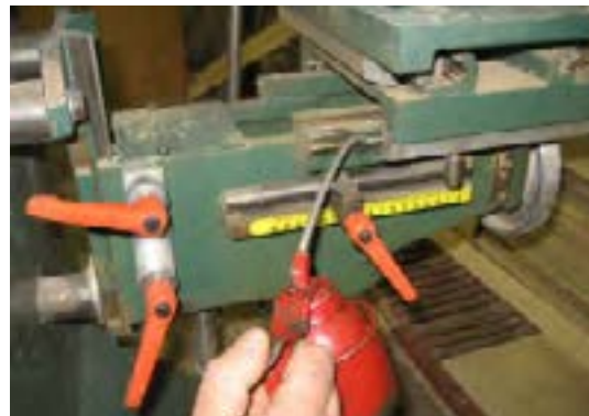
شکل ۱۰-۱- (روغن‌کاری ریل‌ها و کشوهای صفحه‌ی متمرک.
