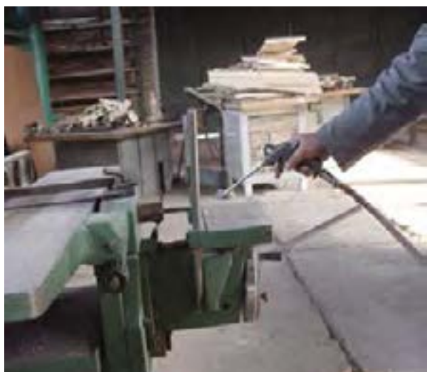
شکل ۱۰-۱۱- غبارگیری قطعات ماشین.
