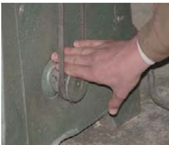
شکل ۶-۱۰-۱- مراقبت از انگشتان به هنگام تعویض تسمه.
