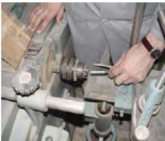
شکل ۷-۱۰-۱- خارج کردن مته از سه‌نظام.
