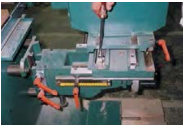
شکل ۱۴-۱- کنترل پیچ‌های دستگاه هدایت.
