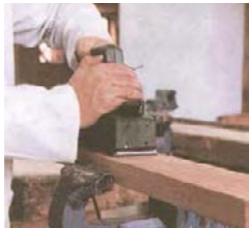
شکل ۱۷-۱۴- نمونه‌ی بستن چوب دافل گیره
