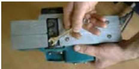
شکل ۱۴-۲۳- خارج کردن تیغه‌ها از جایگاه.
