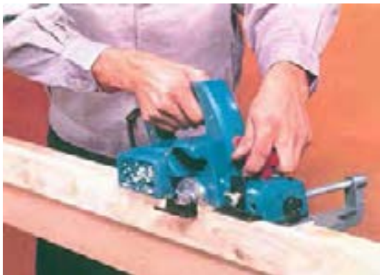
شکل ۱۴-۳۳- تکرار عمل رندیدن چوب، برای به دست آوردن دوراهه‌ی مورد نظر.
