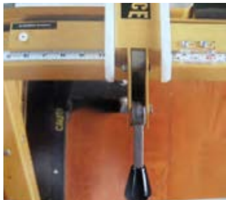
شکل ۱۲-۲۳- تنظیم اندازه‌ی برش.
