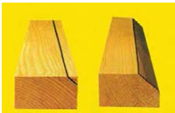
شکل ۳۰-۱۴- چوب فطاکشی شده و پیغ فورده. فط ترسیمی، تا آفرین لمظه باقی می‌ماند.
