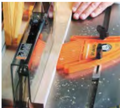
شکل ۱۲-۳۸- استفاده از شانه‌های کمکی.
