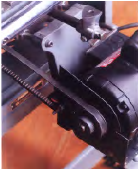
شکل ۱۲-۳۳- تسمه‌ی انتقال نیرو و حرکت.
