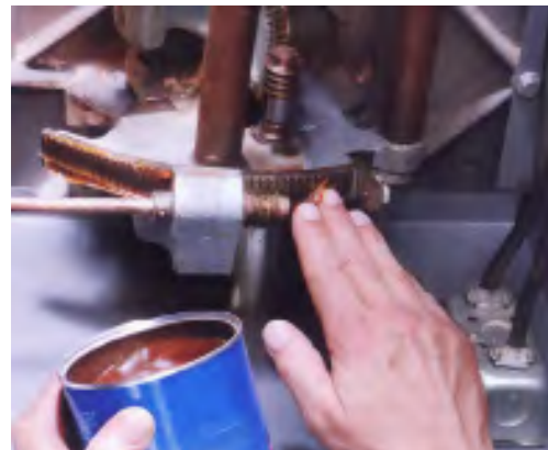
شکل ۱۲-۳۹- گریس‌کاری چرخ دنده‌ها.
