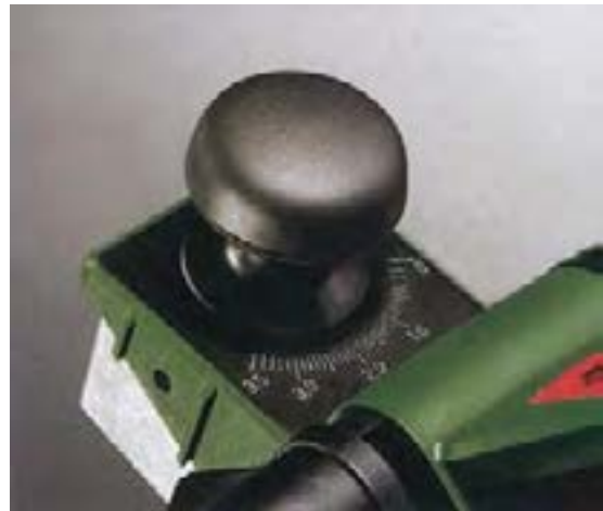
شکل ۴- ۱۴- پیچ تنظیم صفحه برای پوشالبرداری
