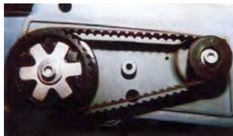
شکل ۹-۱۴- وضعیت قرار گرفتن تسمه روی پیرغدنده.
