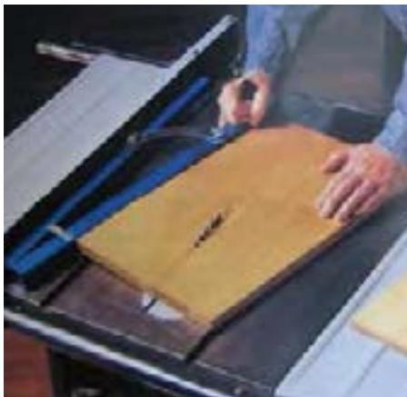
شکل ۱۲-۲۹- برش مورب با ابزار کمکی.
