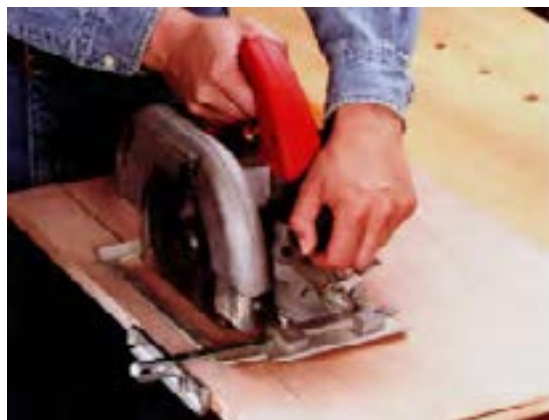
شکل ۱۳-۱۶ برش با استفاده از گونیای ماشین.
