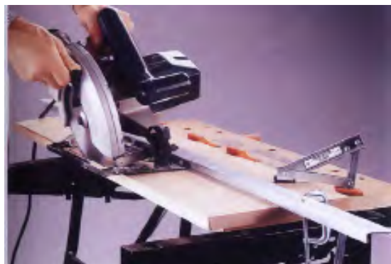
شکل ۱۳-۱۴ برش با استفاده از تکیه‌گاه.
