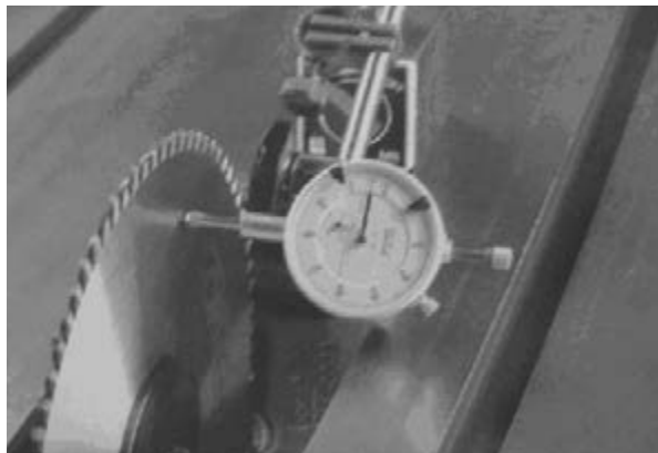
شکل ۱۲-۲۴- کنترل لنگی تیغه با دستگاه لنگی‌سنج.
