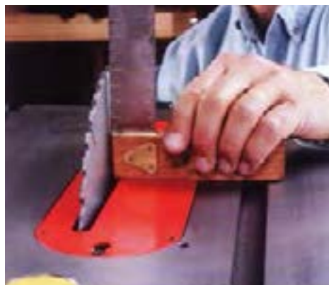
شکل ۱۲-۲۲- کنترل و تنظیم گونیا یی بودن تیغه.
