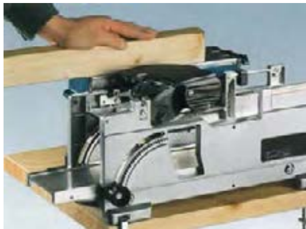
شکل ۱۴-۲۰- کاربرد میز کمکی در موقع رندیدن.
