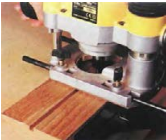
شکل ۱۶-۳- کنشکاف زدن، با دستگاه اور فرز.
