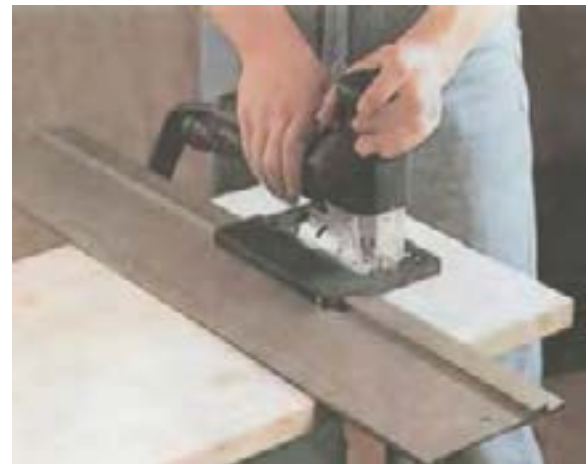
شکل ۱۵-۲۰- برش عرضی چوب به کمک ریل راهنما.
