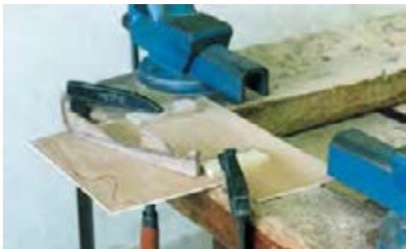
شکل ۱۵-۴۶ - قطعه کار، با روشی درست و با گیره دستی روی میز ممکّم می‌شود.
