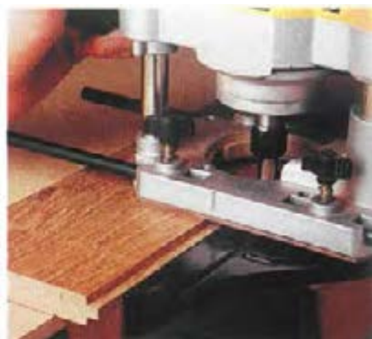
شکل ۱۶-۴ - دوراهه زدن، با دستگاه اورفرز.
