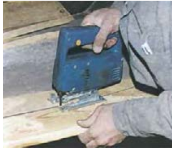
شکل ۱۵-۱۹- برش طولی چوب بدون استفاده از گونیا.
