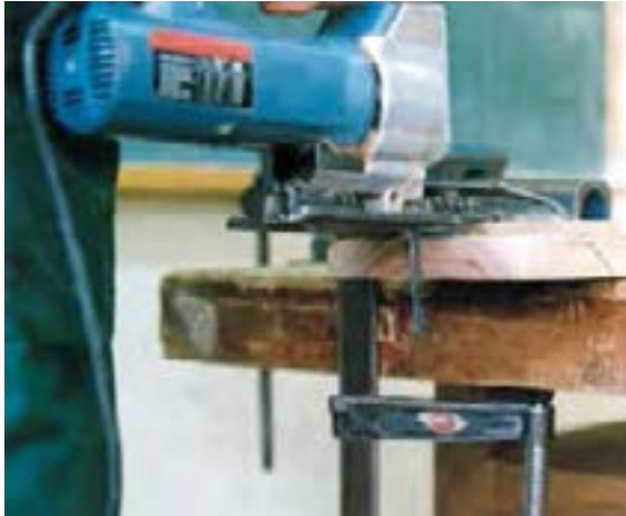
شکل ۱۵-۳۵. صفحه، کاملاً روی چوب قرار نگرفته است.
