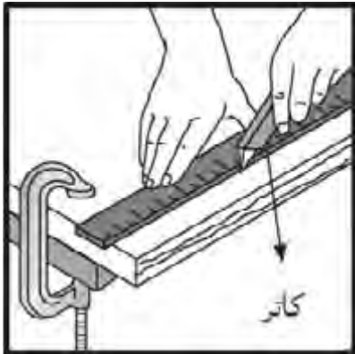
شکل ۱۵-۲۱- تعیین مسیر برش توسط فمکش و کاتر
