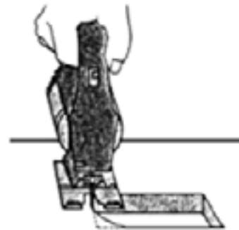
شکل ۱۵-۳۷- نمونه‌ی بریدن گوشه‌های داخلی با زاویه‌ی ۹۰ درجه.
