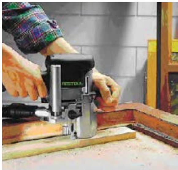
شکل ۱۶-۷- برداشتن قسمت اضافی سه لایه.
