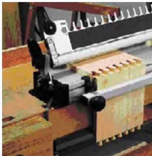
شکل ۱۶-۵- اتصال دم چلچله و انگشتی.
