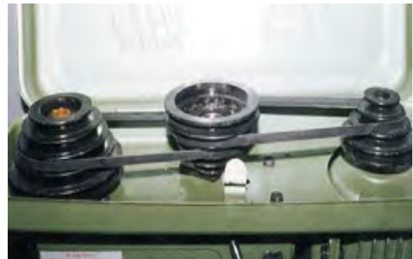
شکل ۱۹-۱۳. تغییر دور پله‌ای در دستگاه دریل ستونی.
