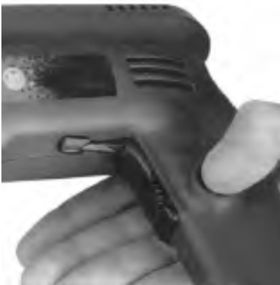
شکل ۱۹-۴۳ - رها کردن کلید و کار دائم دریل.
