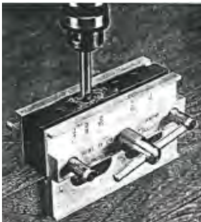
شکل ۱۹-۵۶- سوراخ‌کاری با استفاده از شابلن.
