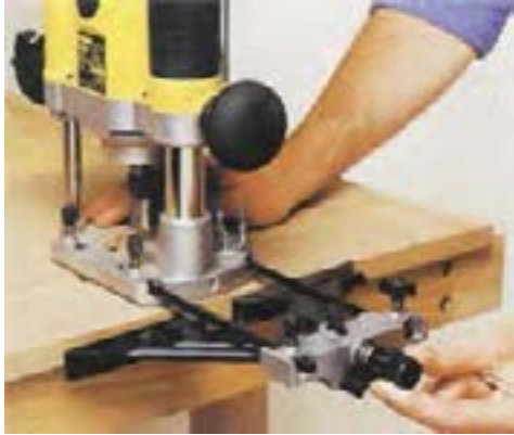
شکل ۱۶-۲۱- تنظیم گونیا هنگام کار با تیغه‌های بدون گلتک
