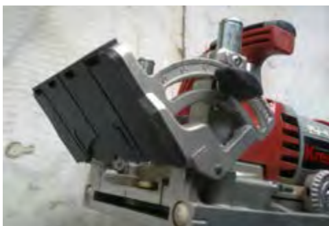
شکل ۴-۱۷- گونیا‌ی یک دستگاه فرز بیسکویتی.
