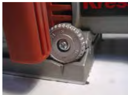
شکل ۱۷-۵- پیچ تنظیم عمق شیار.
