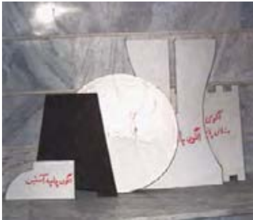
شکل ۳- ۱۸- چند نمونه الگوی آماده شده از مواد مفتلف.
