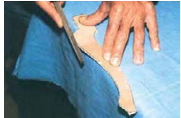
شکل ۱۸-۲۲- نمونه‌ی پرداخت کردن مسیر برش.
