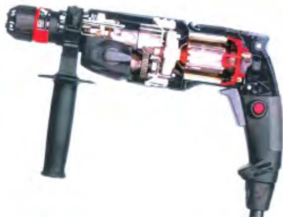
شکل ۱۹-۴۵- وضعیت قرارگیری قطعات در داخل پوسته‌ی دریل.
