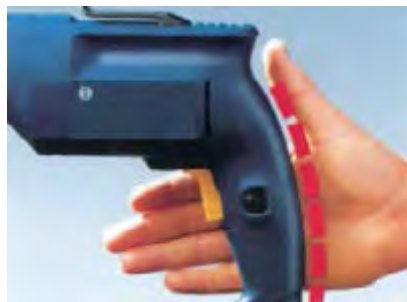
شکل ۱۹-۴۰ - دسترسی دکمه‌ی روشن و خاموش دریل.
