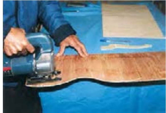
شکل ۱۸-۲۱- برش تخته سه‌لایه با توجه به طرح الگو.
