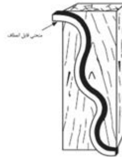
شکل ۹-۱۸. نمونه‌ی کار با منحنی قابل انعطاف (روی چوب).
