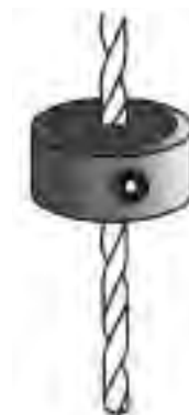
شکل ۱۹-۵۳- قطعه به‌جای میله‌ی عمق سنج.
