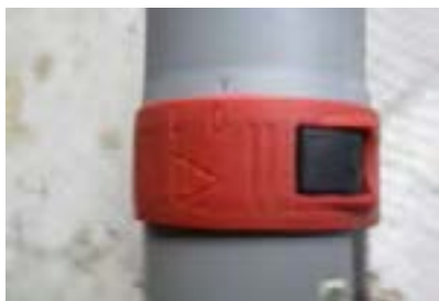
شکل ۱۷-۷ - کلید قطع و وصل دستگاه فرز بیسکویتی
