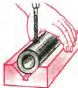
شکل ۱۹-۳۸ - سوراخ‌کاری جسم استوانه‌ای.
