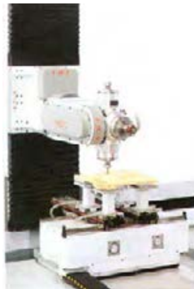
شکل ۸- دستگاه C.N.C برش بر روی چوب.
