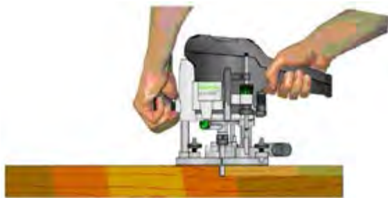
شکل ۱۶-۲۶- دوراهاه زدن قطعه کار با دستگاه اورفرز.
