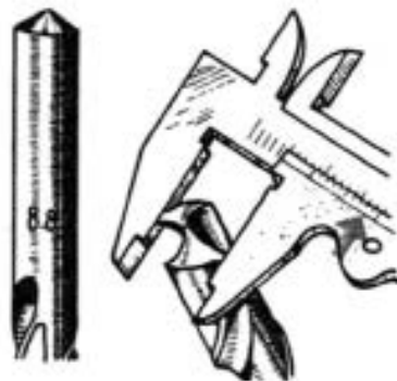
شکل ۱۹-۴۸- اندازه‌گیری قطعه به وسیله‌ی کولیس.
