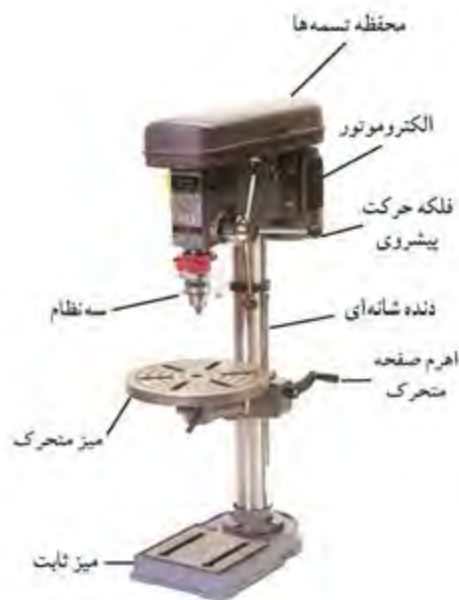
شکل ۱۹-۴- دریل ستونی پایه‌دار و قسمت‌های آن.
