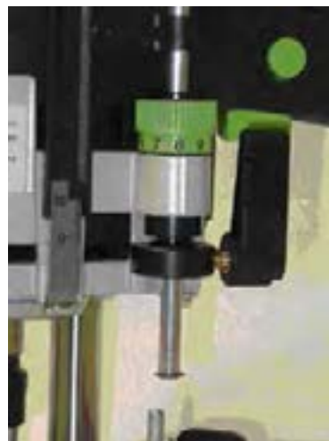
شکل ۱۳-۱۶- درجه‌ی تعیین ارتفاع تیغه.
