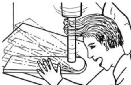
شکل ۱۹-۲۶- درگیر شدن مته با موی سر.
