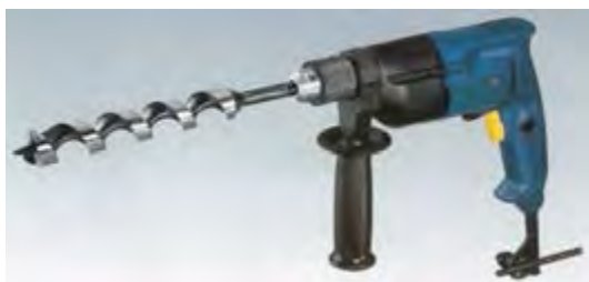
شکل ۱۹-۶- دریل با دور بسیار کم، برای استفاده از مته‌های مارپیچ.
