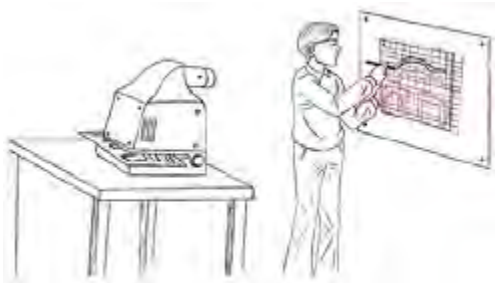
شکل ۱۶-۱۸. استفاده از پروژکتور اوپک برای بزرگنمایی.
