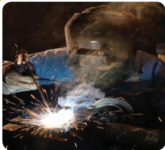
تخلیه بار الکتریکی بین نوک الکتروود و سطح قطعه کار سبب ایجاد قوس می‌شود.
