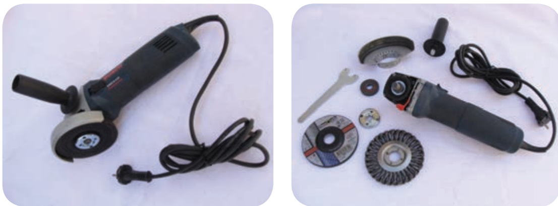
سنگ سنباده دستی و اجزای مربوط به آن
