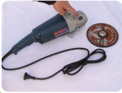
کلید مخصوص قفل کردن محور سنگ
