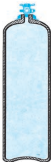
کپسول فولادی مخصوص برای ذخیره اکسیژن
