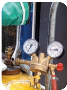
محکم کردن اتصالات رگولاتور به کپسول گاز
