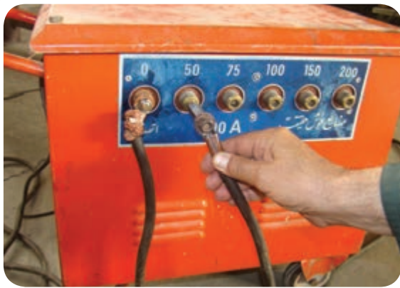
تنظیم آمپر در دستگاه ترانسفورماتور پله‌ای
