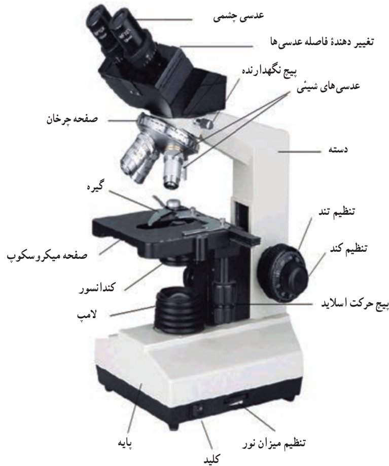
شکل ۲-۴- بخش‌های اصلی یک میکروسکوپ نوری
