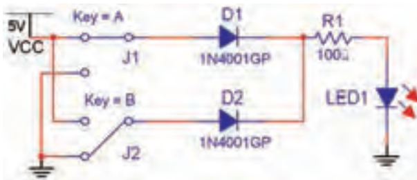
شکل ۱-۵ مدار دیودی گیت OR در حالتی که کلید A وصل و کلید B قطع است.
