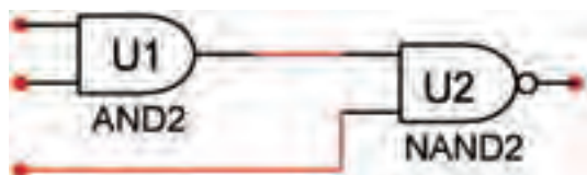
شکل ۲-۴۳ گیت NAND با سه ورودی
