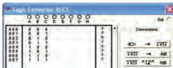
شکل ۲-۲۵ تنظیم جدول صحت روی دستگاه مبدل منطقی
