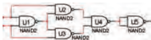
شکل ۲-۵۵ گیت XNOR با استفاده از پنج گیت NAND
