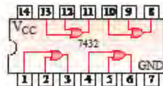
(الف) آی سی ۷۴۳۲ گیت OR
