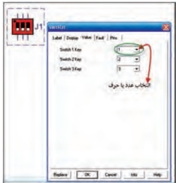
شکل ۳-۳۰ انتخاب حرف یا عدد برای صفحه کلید کامپیوتر جهت تغییر حالت کلیدها
