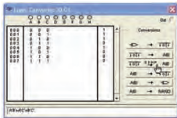
شکل ۳-۳ تبدیل جدول صحت به تابع F_p با استفاده از دستگاه مبدل منطقی
