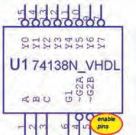
شکل ۲۴-۳ آی‌سی ۷۴۱۳۸ یک رمزگشای ۳ به ۸
